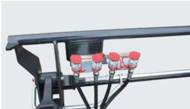
3-й і 4-й контур управління (тут у вигляді з'єднувальної муфти) Для простого управління гідравлічними робочими органами, наприклад, захватом для силосу, захватом для тюків, вилами-штабелеукладальником для тюків.
