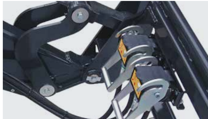
Робочий орган Fix 2-хорова муфта для 3-го і 4-го контуру управління.
