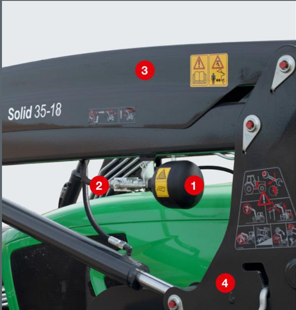
El Comfort-Drive queda protegido entre el pilar izquierdo y el brazo. Mediante la llave de paso puede conectarlo y desconectarlo cuando lo necesite.
