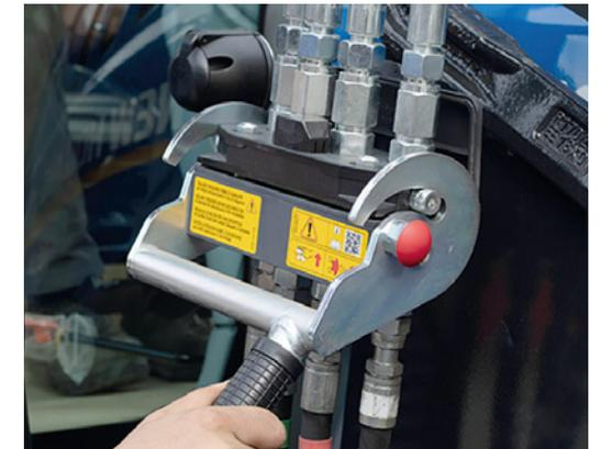
**2** El Hydro-Fix le permite enganchar todos los latiguillos a la vez ¡y bajo presión! Una vez en el tractor, levante ligeramente la pala, y el bulón superior quedará retenido en el gancho.
