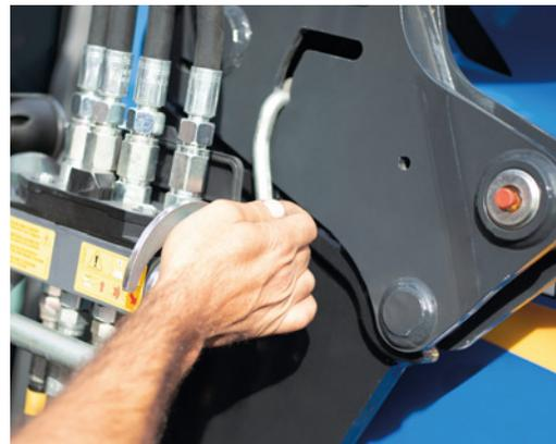
**3** Baje la palanca de cierre para que el montaje quede seguro. Levante más la pala.
