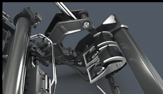
OSPRZĘT FIX. Złącze podwójne do 3. i 4. obwodu sterowniczego. Do jeszcze szybszego połączenia przewodów hydraulicznych złącze Hydro-Fix jest dostępne również do montażu osprzętu.
