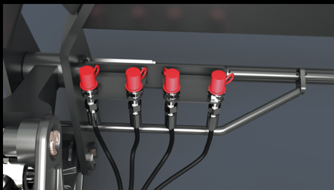
3. I 4. OBWÓD STEROWNICZY. (tutaj w postaci złącza wtykowego) Do łatwej obsługi osprzętu hydraulicznego, np. wycinaka do kisonki, chwytaka balotów lub sztaplarki do balotów.
