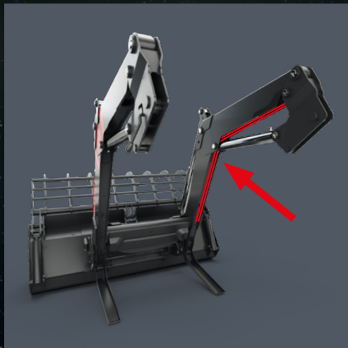
Układanie rur dla REAL 3 rd
