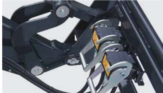
Werktuig Fix 2-voudige koppeling voor de 3 e en 4 e stuurkring.
