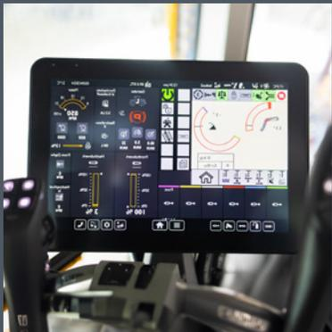
Benutzerfreundliche, visualisierte Steuerung und Einstellung der Frontladerparameter über das integrierte Display des Traktors.
