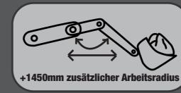
Das STOLL Teleskop-Lader Konzept X-Tra Lift ist mit teleskopierbaren Profilen und einem Schwenkgelenk ausgestattet. Die verbauten Profile sind aus hochfesten und gleichzeitig leichten Stählen und in einem seit vielen Jahren bewährten Profildesign.
