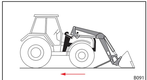
Fig. 125 Retirar el tractor hacia atrás
