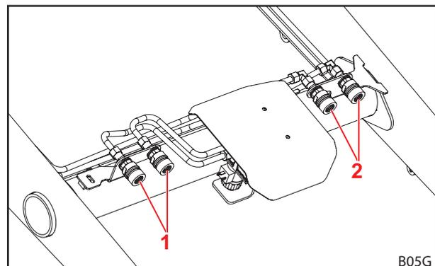
Fig. 46 4.º circuito de control adicional
