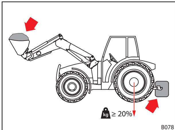
Fig. 50 Carga al trabajar con el cargador frontal
