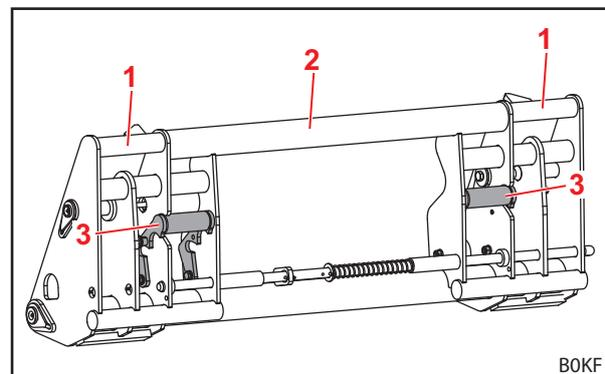
Fig. 18 Cuadro de cambio combinado Euro-SMS (preparado para implemento SMS)
