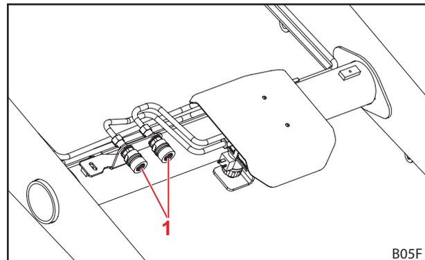
Fig. 45 3er circuito de control adicional
