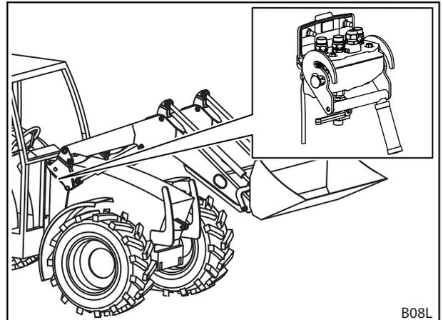
Fig. 24 Hydro-Fix: posición en el cargador frontal
