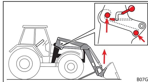
Fig. 57 Utilizar la función *Elevar* hasta que los bulones del cargador frontal tengan contacto con el gancho de retenida
