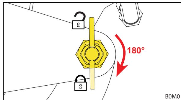
Fig. 39 Colocar el pasador de retención en posición bloqueada
