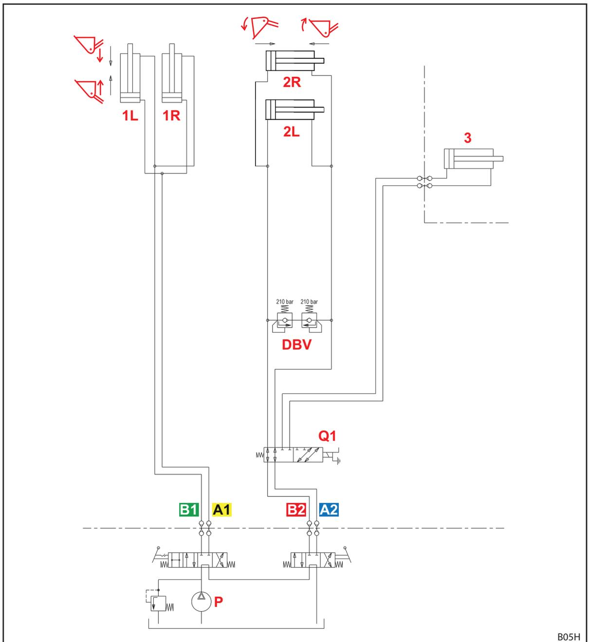
Fig. 126 Esquema hidráulico H
