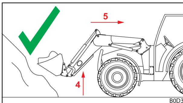
Fig. 114 Marcha atrás bajo carga – correcta
