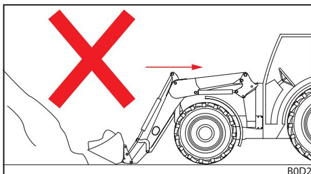
Fig. 113 Marcha atrás bajo carga – incorrecta
