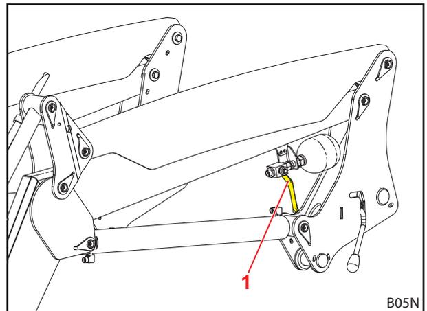
Fig. 47 Comfort-Drive accionado mecánicamente
