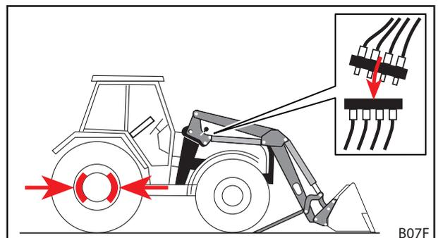
Fig. 55 Desconectar el tractor y conectar los conductos hidráulicos.
