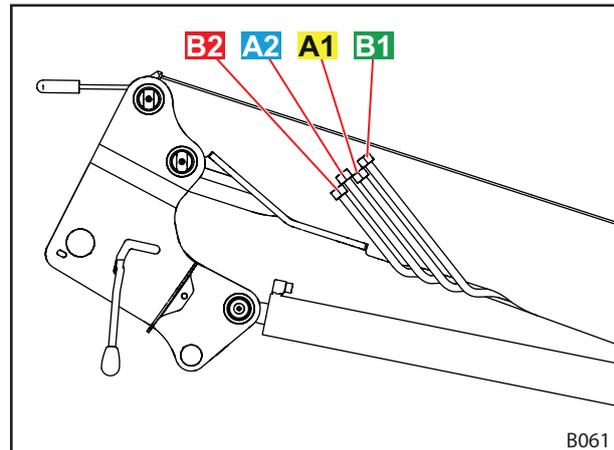
Fig. 22 Conductos hidráulicos
