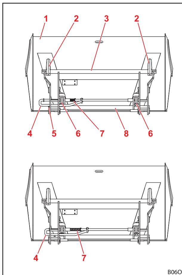
Fig. 26 Bloqueo abierto (arriba) y cerrado (abajo)
