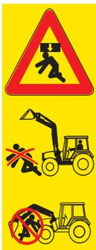
Existe riesgo de aplastamiento y lesiones muy graves debido a movimientos imprevistos del tractor, del cargador frontal así como de los implementos.
