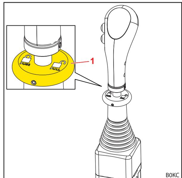
Fig. 68 Bloqueo de la palanca de mando (bloqueo vertical)
