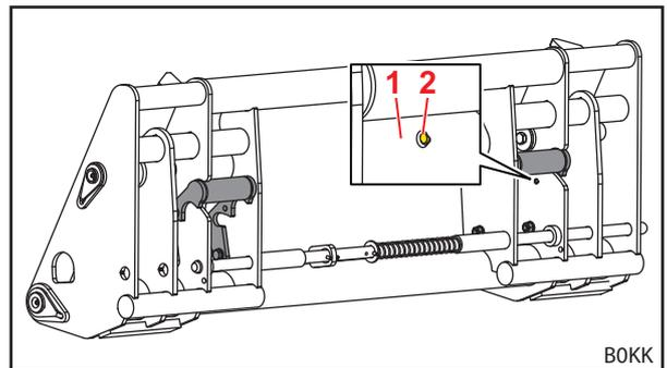
Fig. 92 Apoyos girados hacia arriba (vista posterior)
