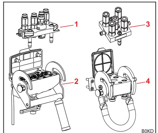
Fig. 25 Estructura de Hydro-Fix y multi-acoplamiento
