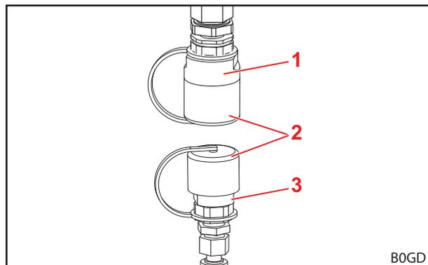
Fig. 80 Acoplamientos roscados (figura de ejemplo)
