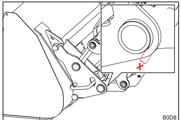
Fig. 120 Medida de desgaste del cuadro de cambio
