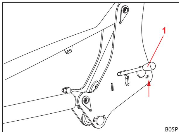
Fig. 60 Abrir el bloqueo del cargador frontal
