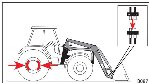
Fig. 100 Unir los conductos hidráulicos del implemento con acoplamientos del cargador frontal
