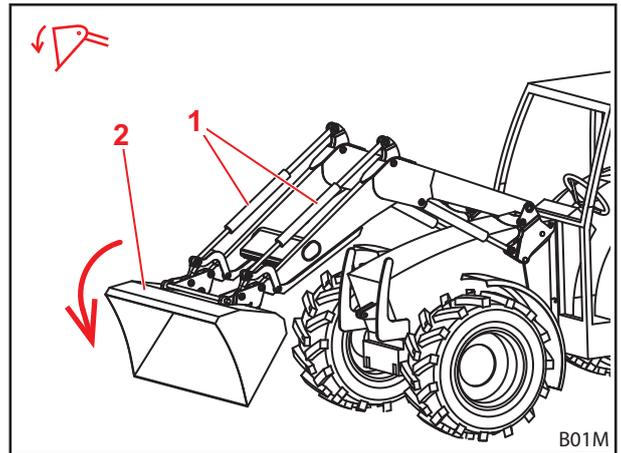
Fig. 31 Función Vaciar
