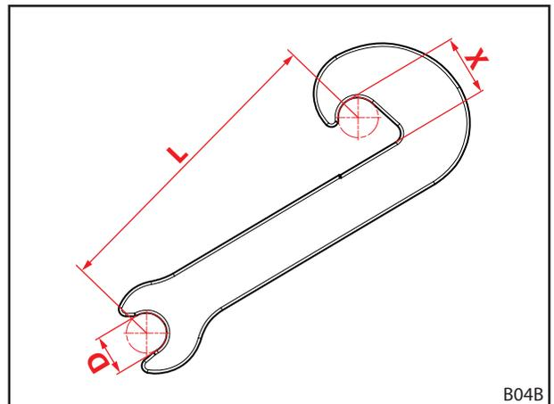
Fig. 118 Valores de desgaste del gancho de retenida
