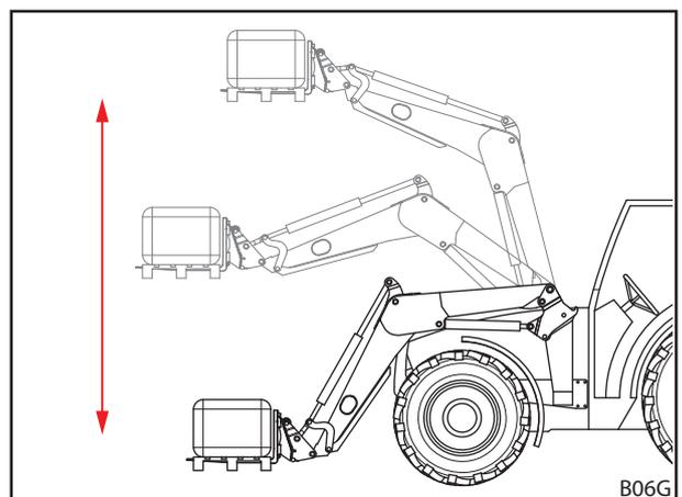
Fig. 34 Guía paralela mecánica
