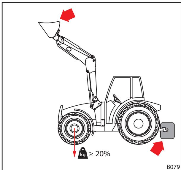
Fig. 51 Carga durante los desplazamientos por carretera
