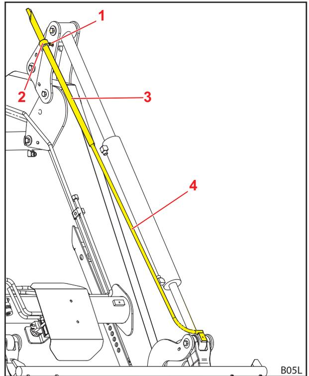
Fig. 33 Indicador visual para el ajuste de implemento
