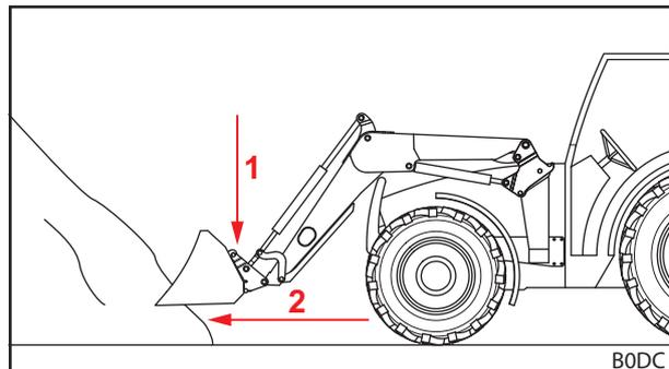
Fig. 111 Bajar el cargador frontal y entrar recto en la carga.
