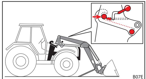
Fig. 54 Introducir el tractor en el brazo oscilante
