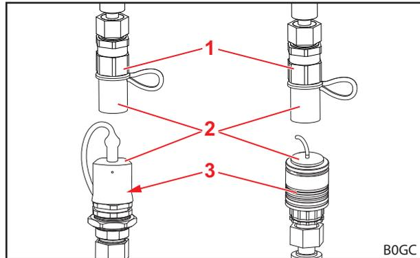
Fig. 79 Acoplamientos por enchufe (figuras de ejemplo)
