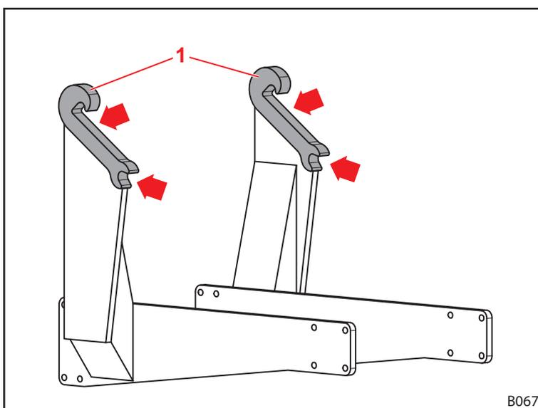
Fig. 115 Puntos de engrase de los alojamientos del cargador frontal
