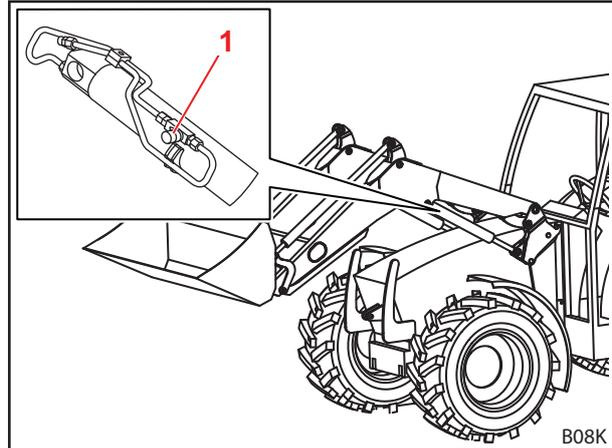
Fig. 48 Válvula de control de descenso
