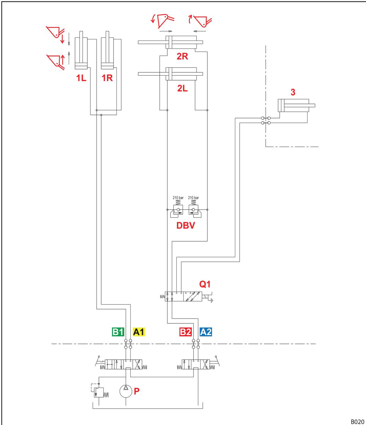
Fig. 127 Esquema hidráulico P
