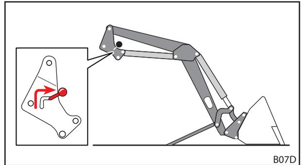
Fig. 53 Abrir el bloqueo del cargador frontal
