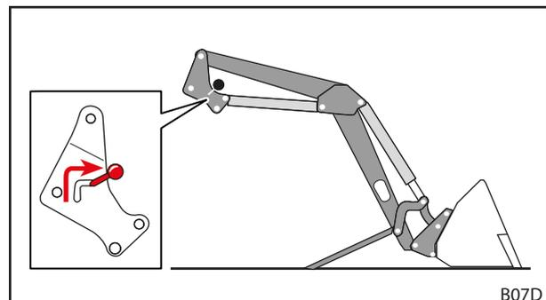
Fig. 50 Abrir el bloqueo del cargador frontal
