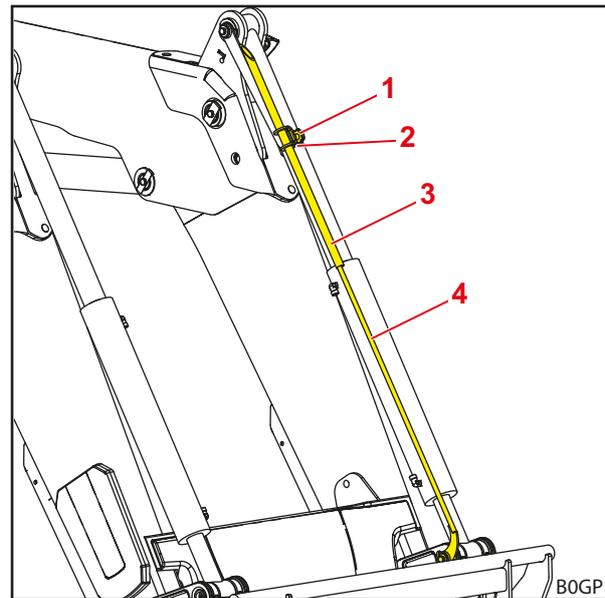
Fig. 30 Indicador visual de posición del implemento
