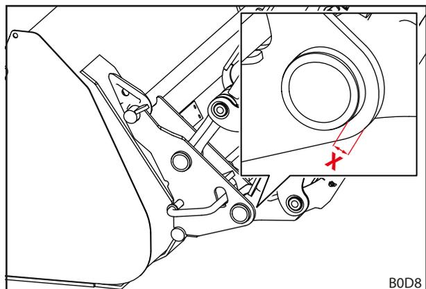
Fig. 124 Medida de desgaste del cuadro de cambio
