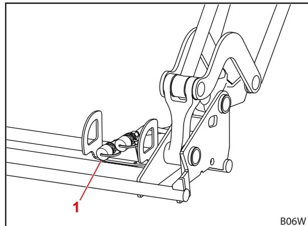
Fig. 35 3er circuito de control adicional
