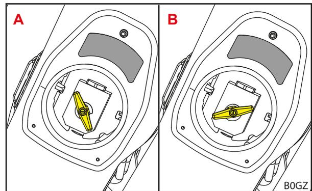
Fig. 39 Posiciones de palanca Comfort Drive
