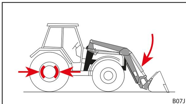
Fig. 125 Aplicar el freno de estacionamiento y bajar el cargador frontal
