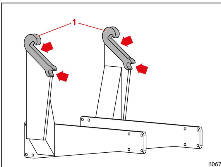
Fig. 117 Puntos de engrase de los alojamientos del cargador frontal
