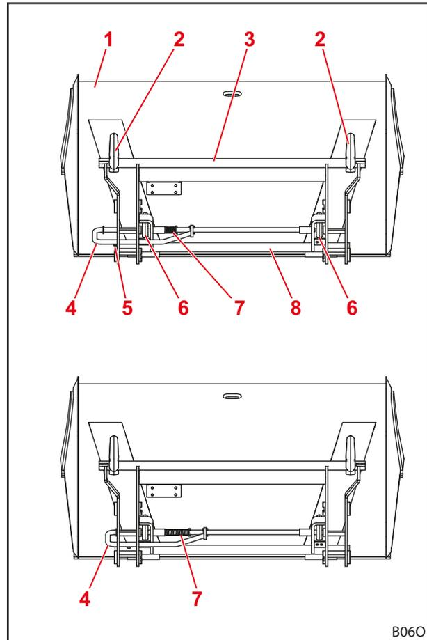
Fig. 23 Bloqueo abierto (arriba) y cerrado (abajo)
