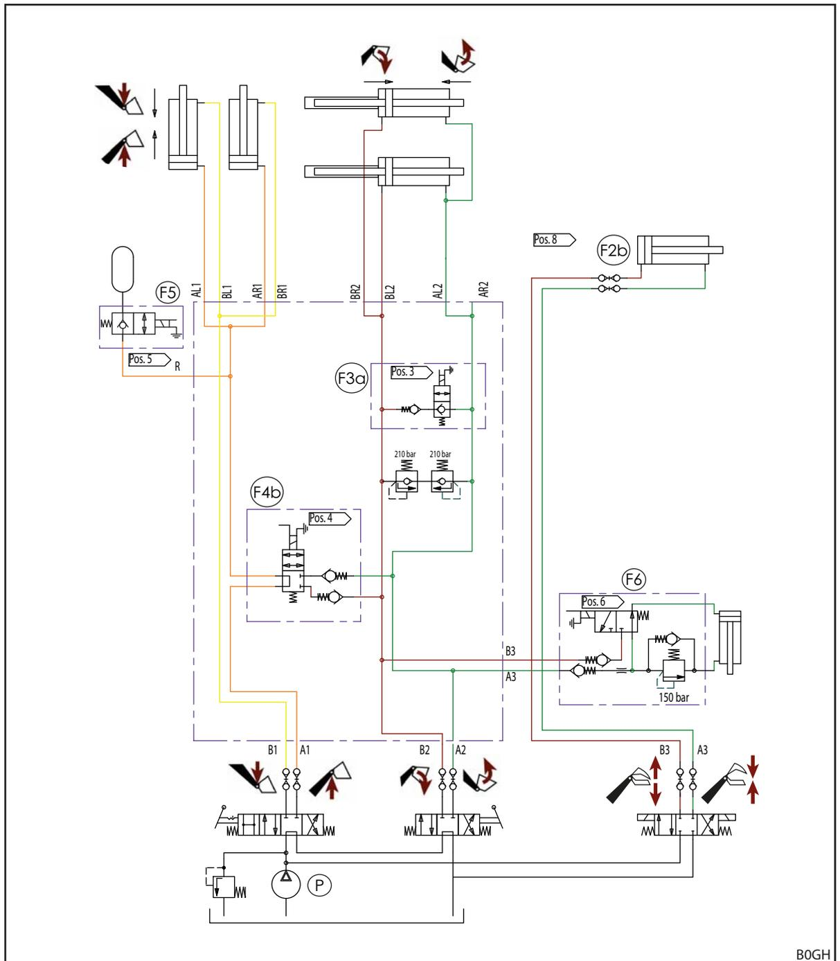
Fig. 134 Esquema hidráulico FZ y FZ-L (en caso de equipamiento con REAL<sup>3</sup>)
