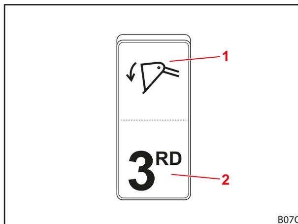
Fig. 73 Interruptor para vaciado rápido y 3er circuito de control o REAL<sup>3</sup>
