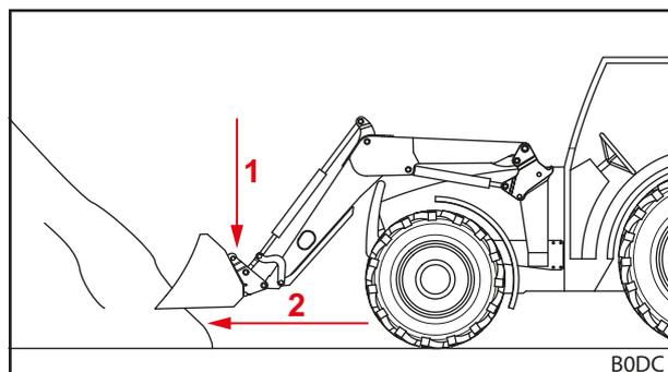
Fig. 113 Bajar el cargador frontal y entrar recto en la carga
