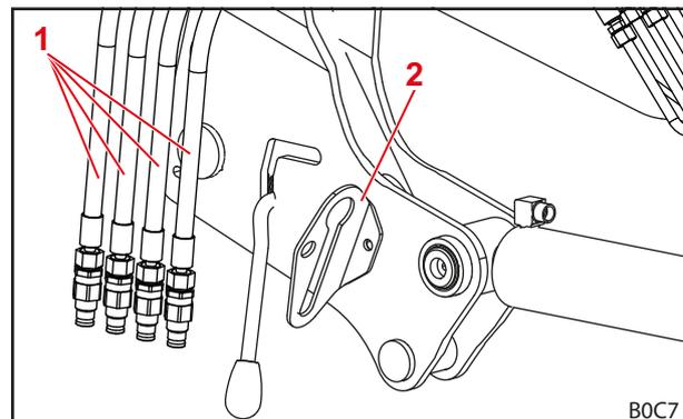
Fig. 130 Enganchar las conducciones hidráulicas a soportes de acoplamiento (representación con acoples de enchufe)
