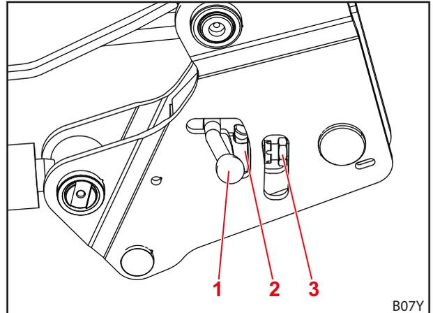
Fig. 60 Abrir el bloqueo del cargador frontal
