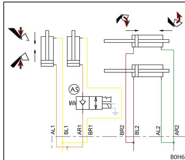
Fig. 135 Esquema hidráulico del seguro contra descenso
