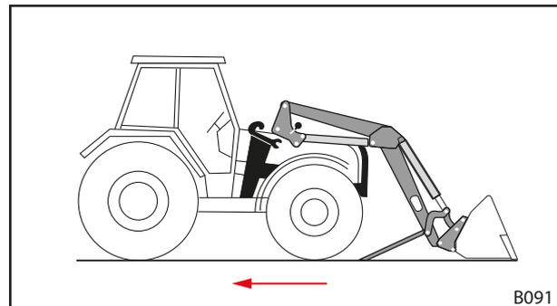
Fig. 129 Retirar el tractor hacia atrás
