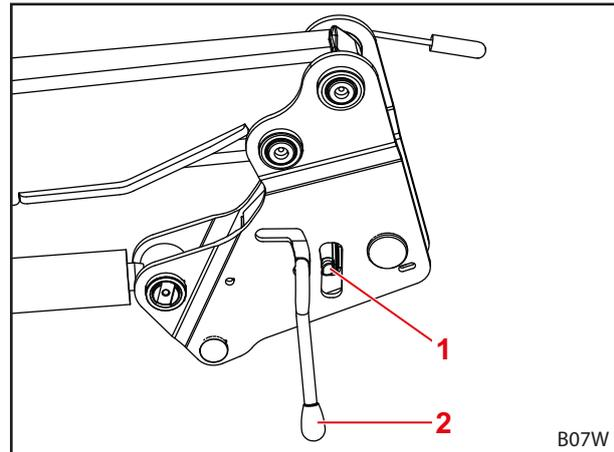
Fig. 122 Comprobar el bloqueo del cargador frontal
