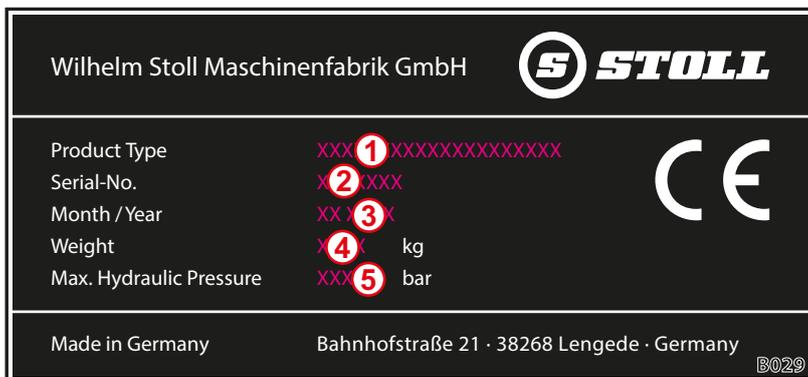
Fig. 1 Placa de características en el cargador frontal
