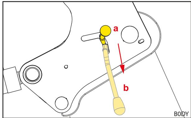
Fig. 58 Sujeción de la palanca de bloqueo
