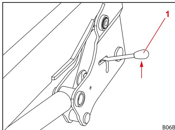
Fig. 56 Abrir el bloqueo del cargador frontal
