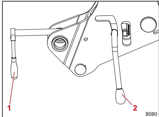
Fig. 62 Guiar la llave de vaso hacia el tornillo
