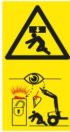
Existe grave riesgo de lesiones y peligro de muerte debido a la caída de implementos o debido al descenso incontrolado del cargador frontal si se utilizan los implementos inapropiados o los utilizados están sobrecargados.
