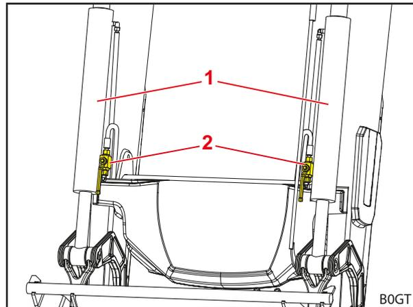
Fig. 42 Grifos de cierre en los cilindros del implemento
