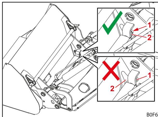
Fig. 93 Comprobar la posición de los pernos de bloqueo
