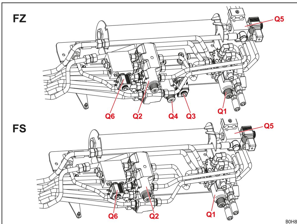
Fig. 139 Disposición de las válvulas hidráulicas para funciones adicionales
