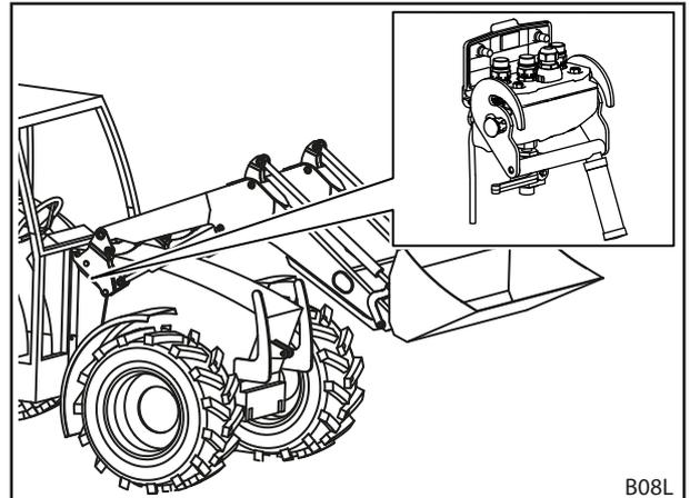
Fig. 19 Hydro-Fix: posición en el cargador frontal
