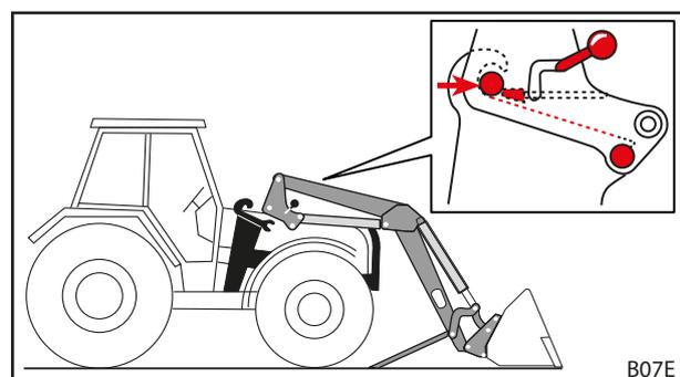
Fig. 51 Introducir el tractor en el brazo oscilante
