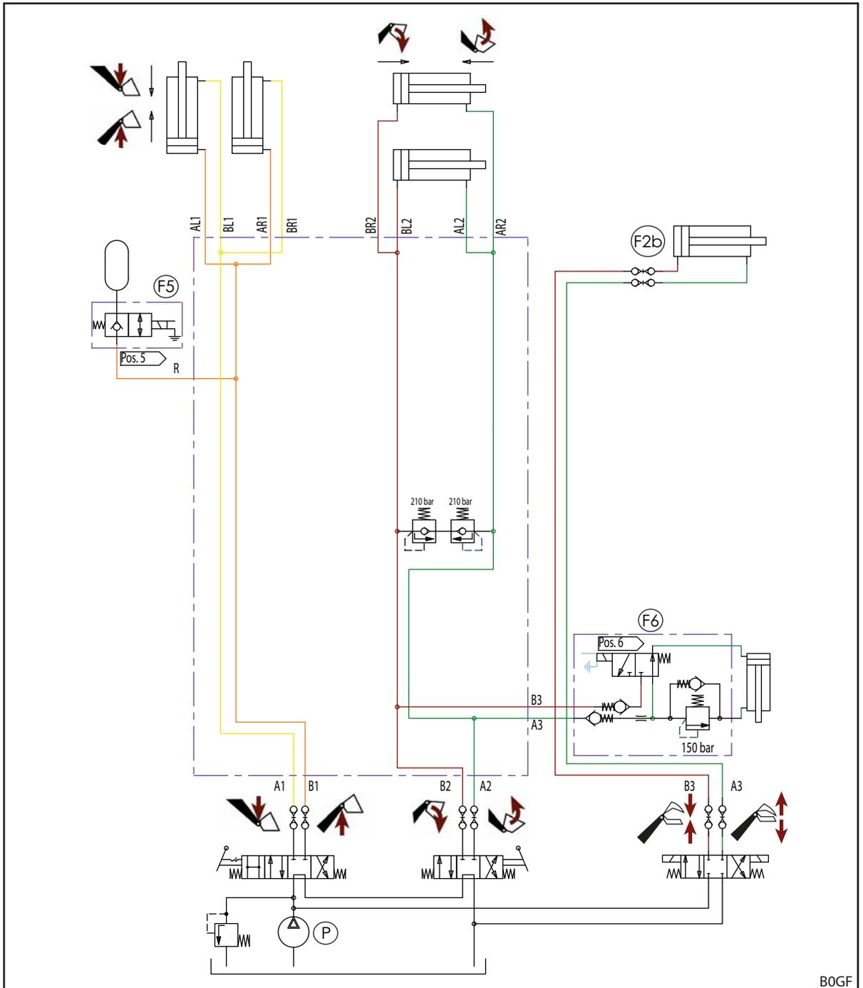
Fig. 132 Esquema hidráulico FS (en caso de equipamiento con REAL<sup>3</sup>)
