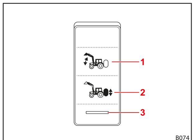
Fig. 77 Interruptor para hidráulica Comfort
