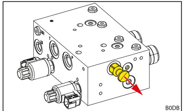
Fig. 76 Extraer la válvula de descarga de presión en la válvula REAL<sup>3</sup>
