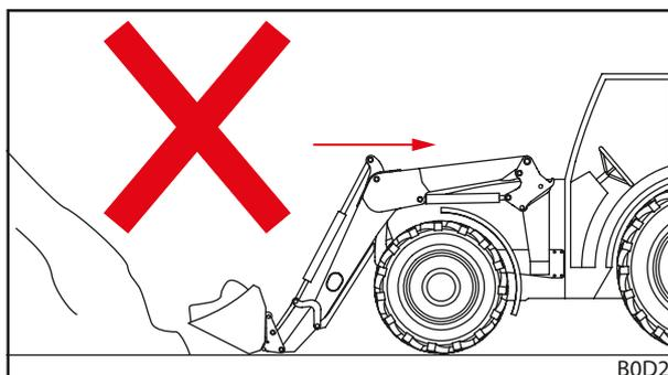
Fig. 115 Marcha atrás bajo carga – incorrecta
