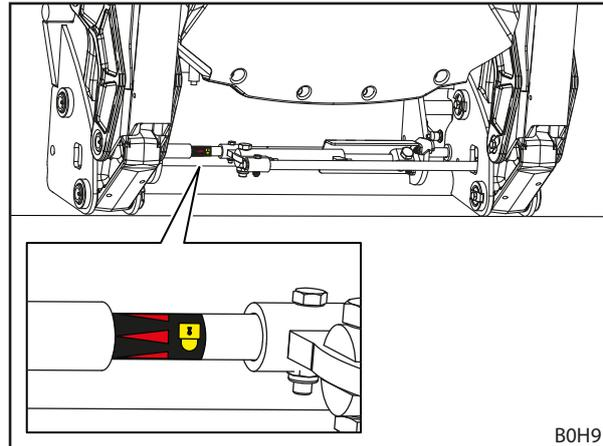
Fig. 92 Comprobar el bloqueo de implemento por medio de la etiqueta
