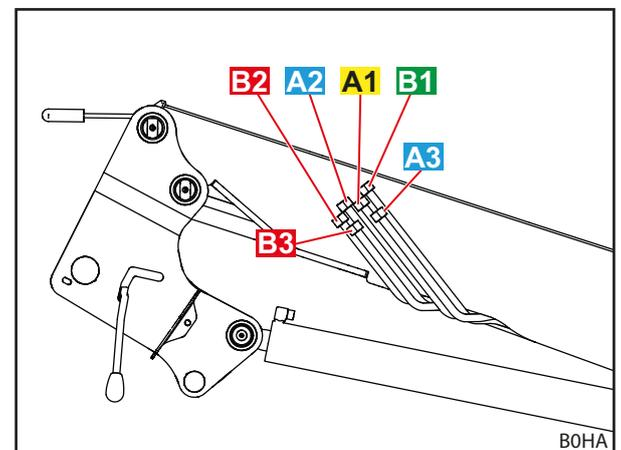
Fig. 16 Conductos hidráulicos (opción REAL<sup>3</sup>)
