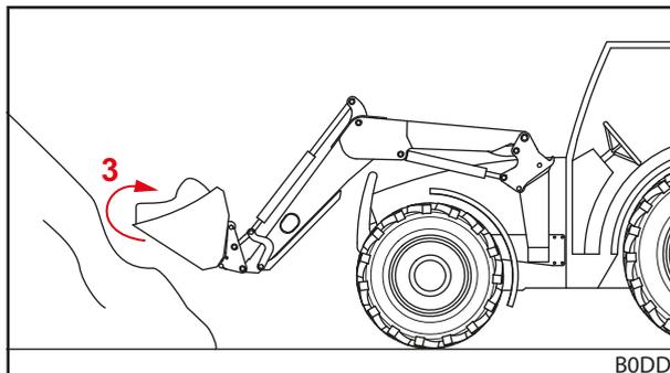
Fig. 114 Volcar el implemento hacia atrás y recoger la carga
