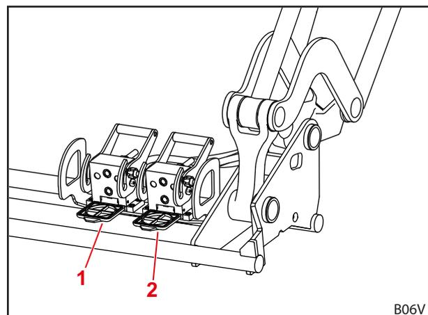
Fig. 36 4º circuito de control adicional
