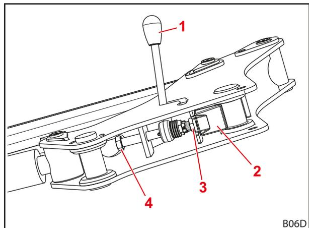
Fig. 59 Vista del bloqueo del cargador frontal desde abajo
