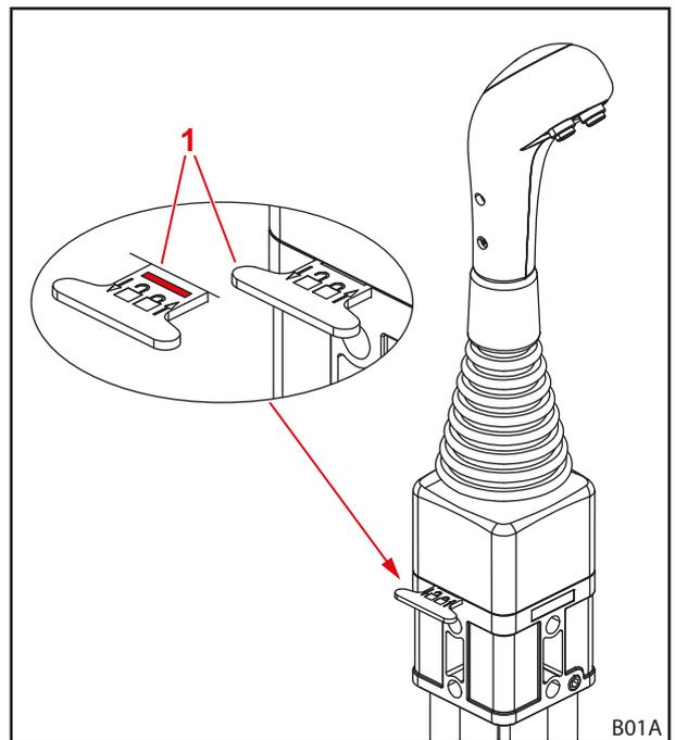
Fig. 68 Bloqueo de la palanca de mando
