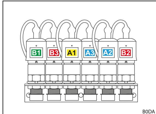
Fig. 18 Conectar acoplamiento por enchufe (opción REAL<sup>3</sup>)
