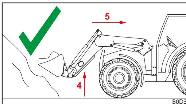
Fig. 116 Marcha atrás bajo carga – correcta
