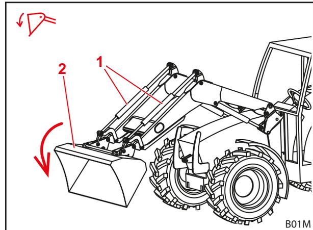
Fig. 28 Función Vaciar
