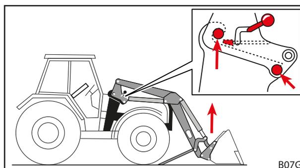
Fig. 53 Utilizar la función *Elevar* hasta que los bulones tengan contacto con el gancho de retenida
