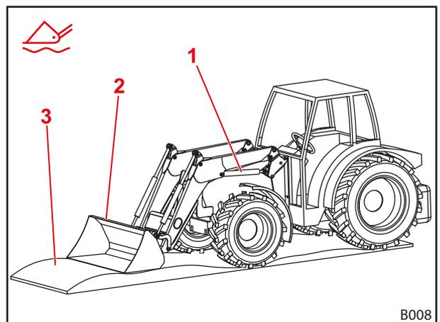
Fig. 29 Cargador frontal en posición flotante
