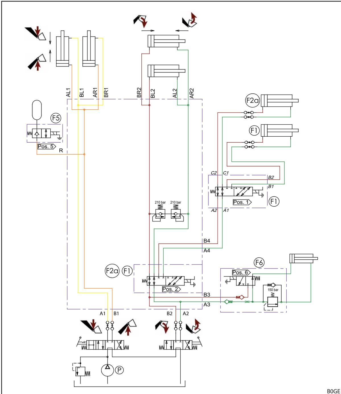
Fig. 131 Esquema hidráulico FS (en caso de equipamiento con 3.er y 4.º circuito de control)
