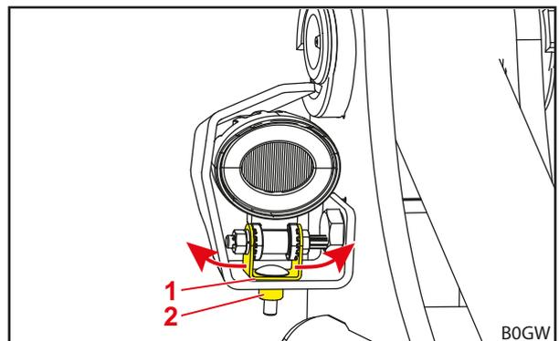
Fig. 44 Ajustar los faros horizontalmente
