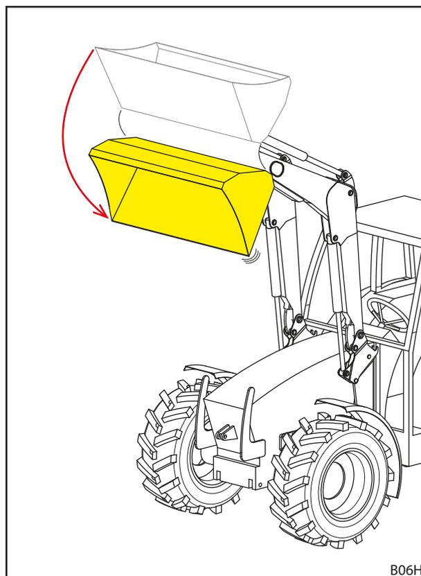
Fig. 32 Vaciado rápido
