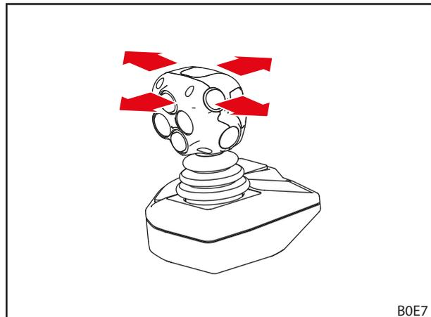
Fig. 71 Mover el joystick en todas las posiciones finales
