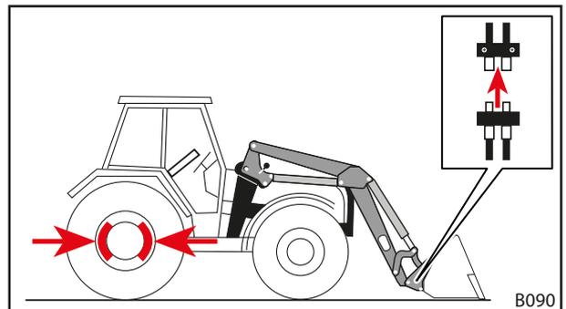
Fig. 108 Soltar conductos hidráulicos
