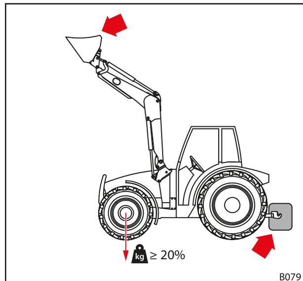
Fig. 48 Carga durante los desplazamientos por carretera
