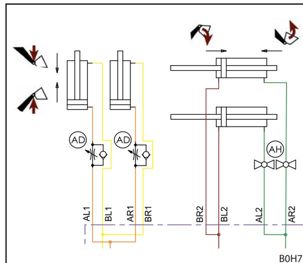
Fig. 136 Esquema hidráulico de la válvula de control de descenso
