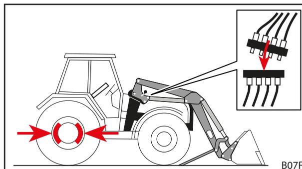
Fig. 52 Desconectar el tractor y conectar los conductos hidráulicos
