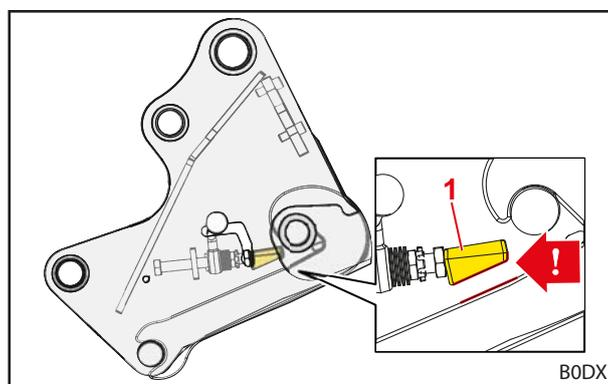
Fig. 55 Posición de montaje correcta de la cuña de apriete
