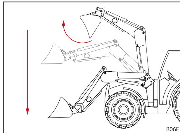
Fig. 33 Función Return-To-Level
