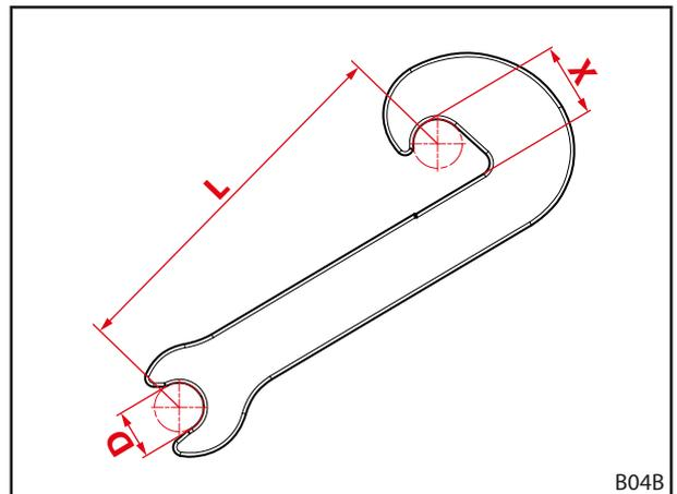
Fig. 120 Valores de desgaste del gancho de retenida
