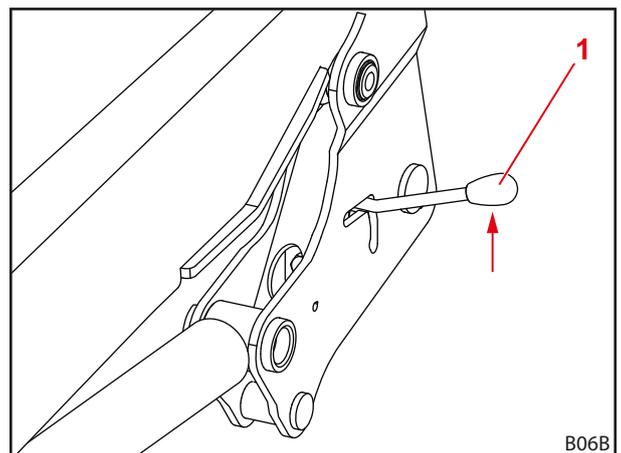
Fig. 121 Comprobar el bloqueo del cargador frontal
