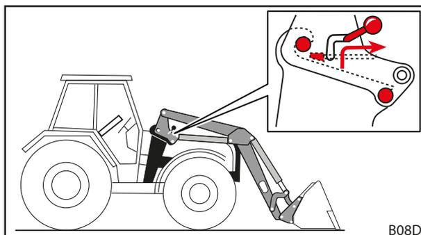
Fig. 126 Soltar el bloqueo del cargador frontal
