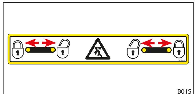
Fig. 91 Comprobar la posición de los indicadores amarillos
