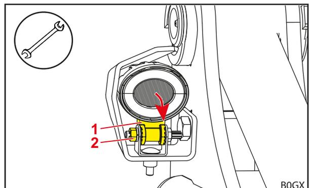
Fig. 45 Ajustar los faros verticalmente
