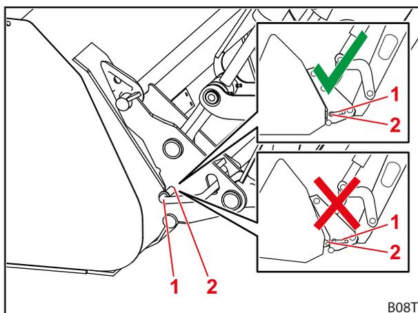
Fig. 86 Comprobar la posición de los pernos de bloqueo
