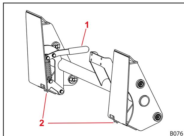
Fig. 88 Bloqueo del implemento en el cuadro de cambio Skid-Steer
