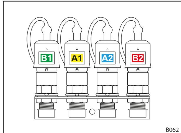
Fig. 17 Conectar acoplamiento por enchufe
