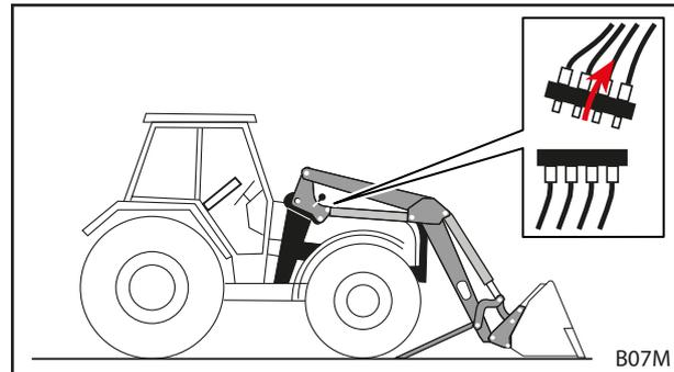
Fig. 128 Desacoplar la hidráulica
