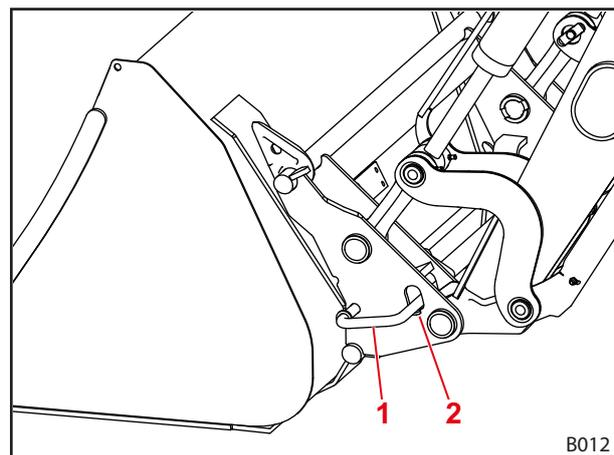
Fig. 84 Bloqueo de implemento mecánico
