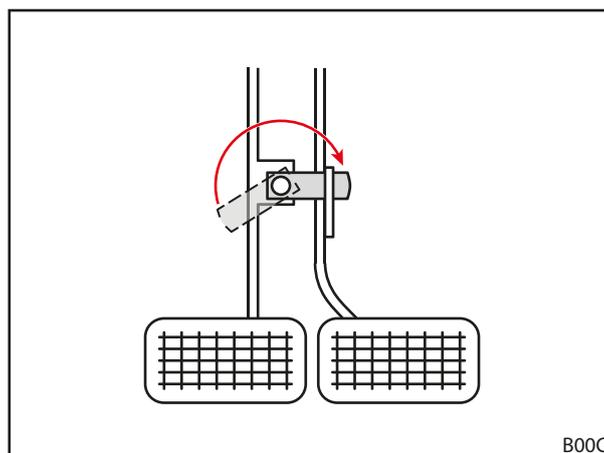
Fig. 46 Conectar los pedales de freno
