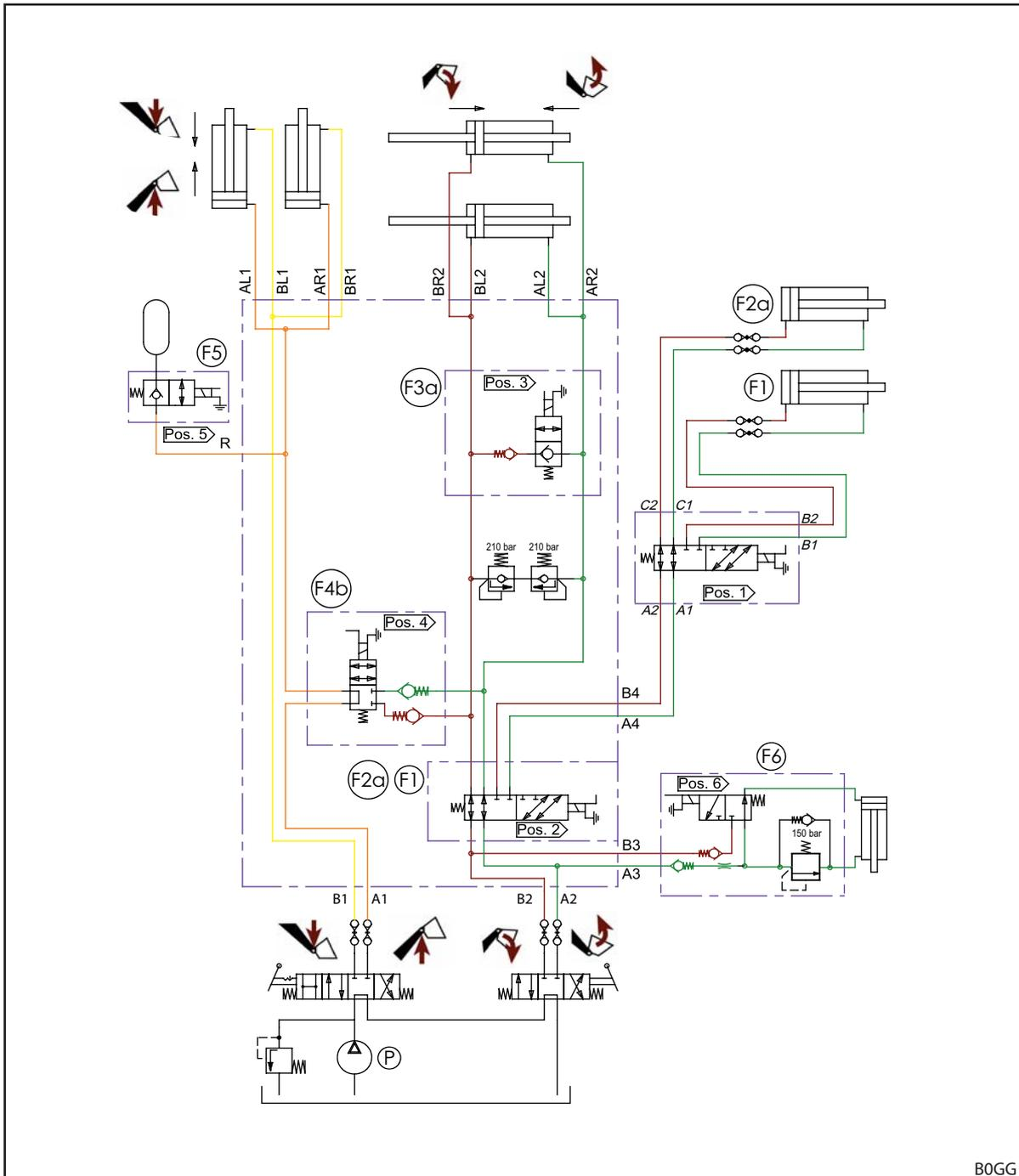
Fig. 133 Esquema hidráulico FZ y FZ-L (en caso de equipamiento con 3.er y 4.º circuito de control)
