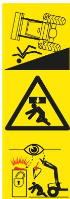
Existe grave riesgo de lesiones y peligro de muerte durante la carga y transporte de carga si está guiando el cargador frontal de un lado, se levanta la carga demasiado sobre el asiento de operador o bien se utiliza implementos inapropiados.
