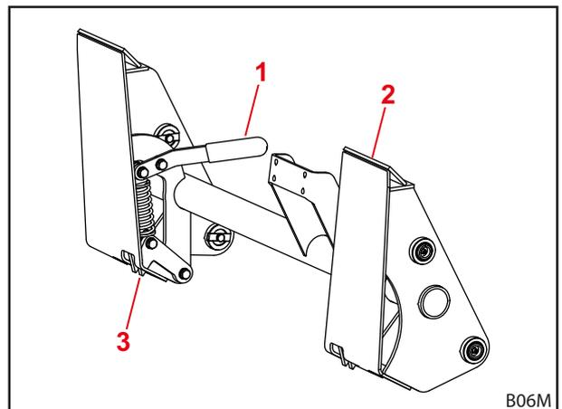
Fig. 24 Bloqueo mecánico del implemento en cuadros de cambio Skid-Steer
