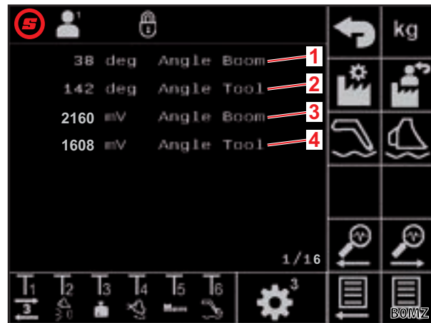
Fig. 37 Sensores de ángulo brazo oscilante e implemento
