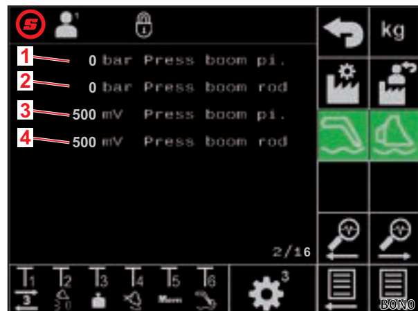
Fig. 38 Sensores de presión del brazo oscilante
