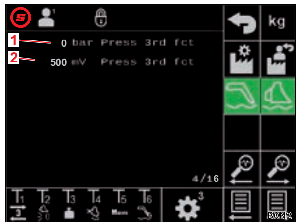
Fig. 40 Sensor de presión en el 3er circuito de control
