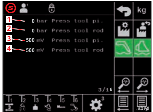
Fig. 39 Sensores de presión del implemento
