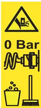
Existe riesgo de aplastamiento si las piezas de máquina se mueven de forma descontrolada debido a la inclusión de aire en el sistema hidráulico.
