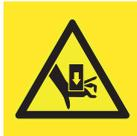
Existe riesgo de aplastamiento de las extremidades al manejar los pies soporte para depositar el cargador frontal, especialmente en terrenos irregulares.
