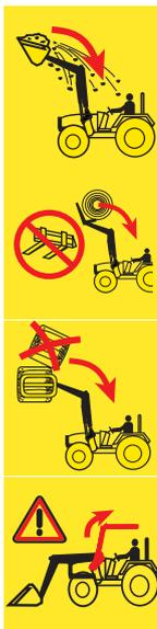
Existe peligro de muerte debido a las cargas elevadas que pueden volcar sobre el asiento del conductor. La elevación de objetos (p. ej. palets o pacas) por encima de la cabina del conductor y el trabajo en pendiente elevan el riesgo. Los sistemas de protección habituales (dispositivo antivuelco ROPS, protección incorporada contra la caída de objetos FOPS) tampoco ofrecen una protección totalmente suficiente.
