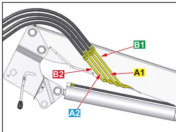
Pri čelnih nakladalnikih brez elektriKE:
