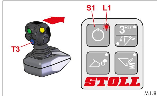
Рис. 47 Запуск режима программирования
