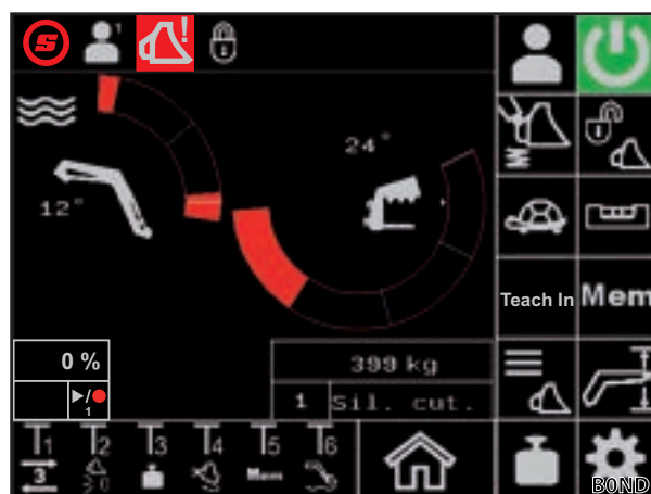
Fig. 36 Afișare protecție la răsturnare/basculare
