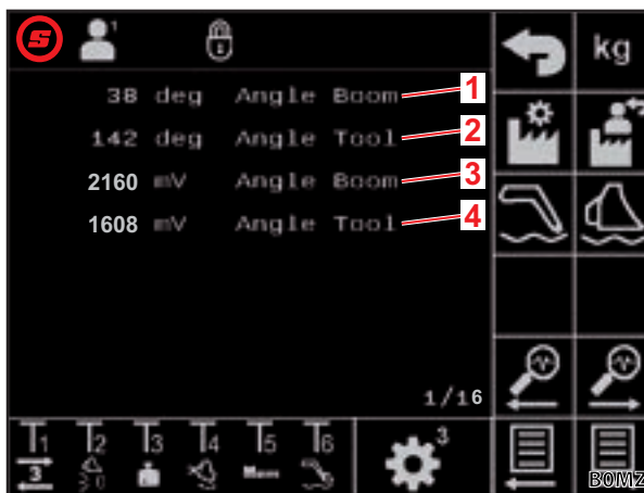
Fig. 37 Senzori de unghi de la brațul oscilant și unealtă
