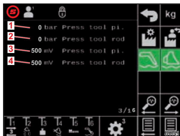
Fig. 39 Senzorii de presiune ai uneltei
