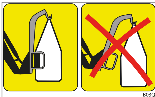
Fig. 79 Poziție corectă (stânga) și neadecvată (dreapta) a uneltei
