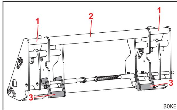
Fig. 17 Armação de troca combinada Euro-SMS (preparada para ferramenta Euro)
