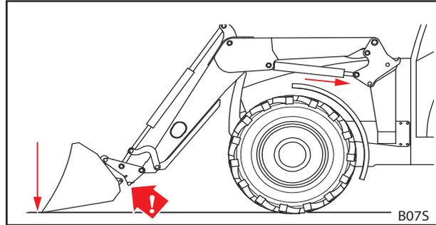
Fig. 86 Pressionar a ferramenta no chão
