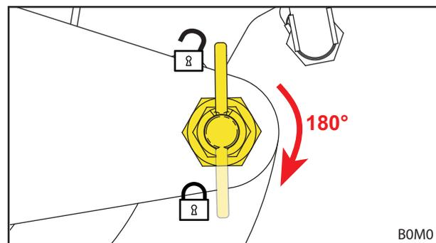
Fig. 39 Colocar o trinco de encaixe na posição bloqueada
