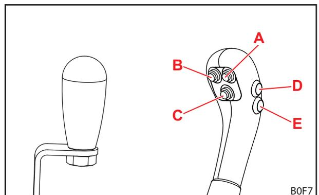
Fig. 70 Alavanca de comando sem botão (à esquerda) e alavanca de comando com 5 botões (à direita)
