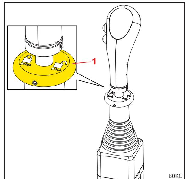
Fig. 68 Bloqueio da alavanca de comando (bloqueio vertical)
