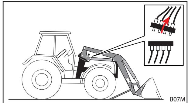
Fig. 124 Desacoplar o sistema hidráulico
