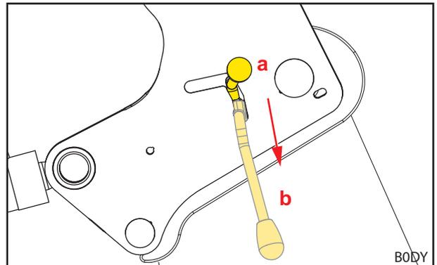
Fig. 62 Processo de fixação da alavanca de bloqueio
