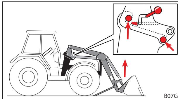
Fig. 57 Utilizar a função *Elevação* até que as cavilhas do carregador frontal estejam fixadas nos anzóis
