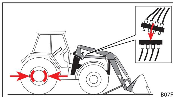
Fig. 55 Desligar o trator e ligar os condutores hidráulicos
