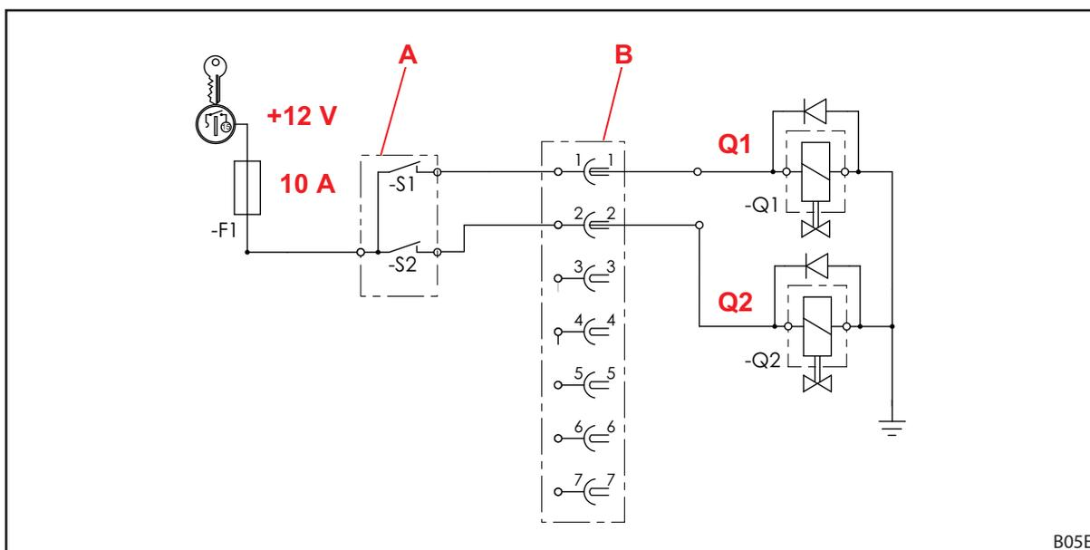
Fig. 128 Esquema elétrico
