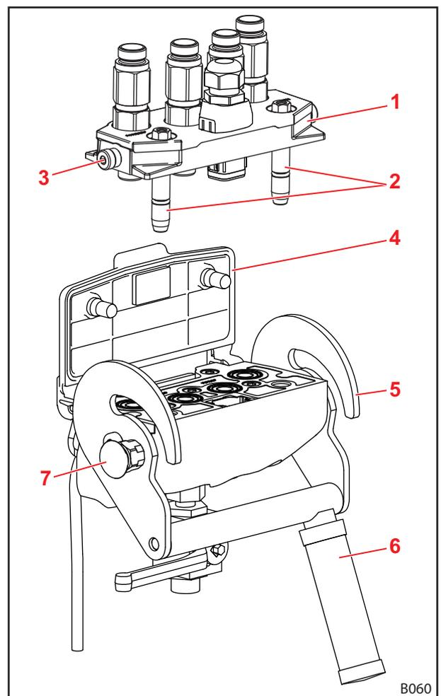
Fig. 81 Hydro Fix (exemplo: Hydro Fix de 4 vezes)
