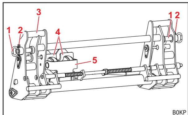
Fig. 20 Armação de troca combinada Euro-FR (preparada para ferramenta Euro)
