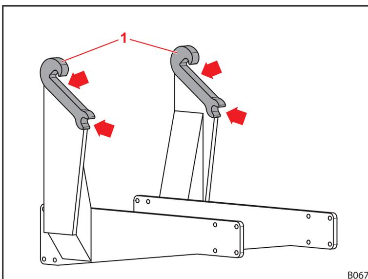
Fig. 115 Pontos de lubrificação dos suportes do carregador frontal
