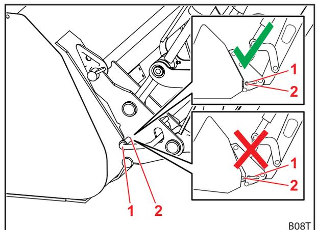
Fig. 85 Verificar a posição dos pernos de bloqueio
