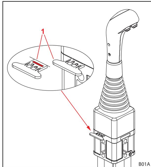
Fig. 67 Bloqueio da alavanca de comando (bloqueio horizontal)
