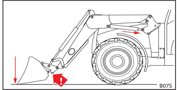
Fig. 88 Pressionar a ferramenta no chão
