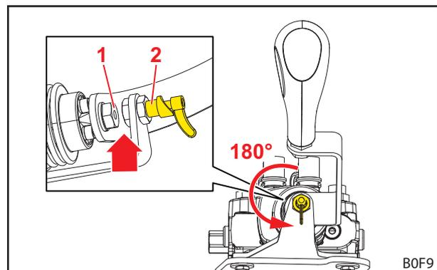
Fig. 72 Alavanca de comando desbloqueado
