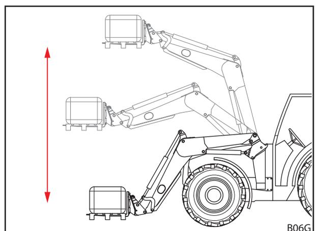
Fig. 34 Versão paralela mecânica
