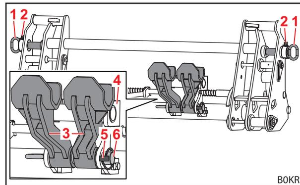
*Fig. 93 Adaptador em posição de estacionamento (armação de troca preparada para a ferramenta Euro)*
