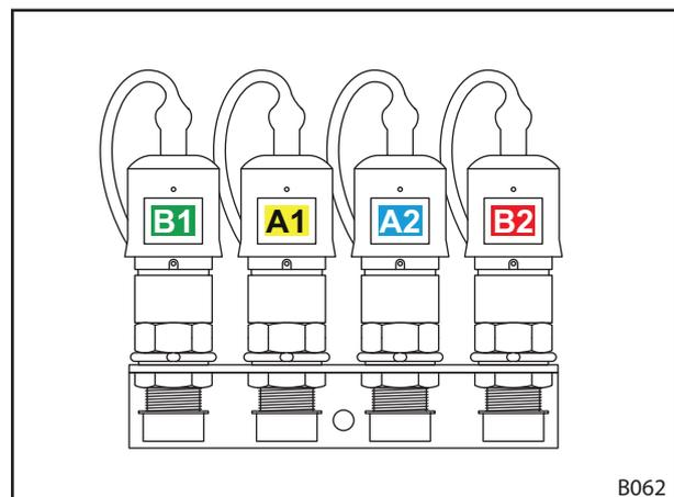
Fig. 23 Acoplamentos de encaixe ligados
