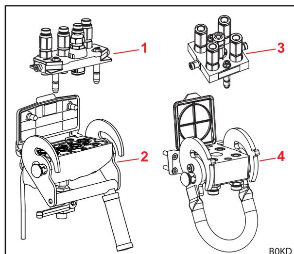
Fig. 25 Estrutura Hydro Fix e acoplador múltiplo
