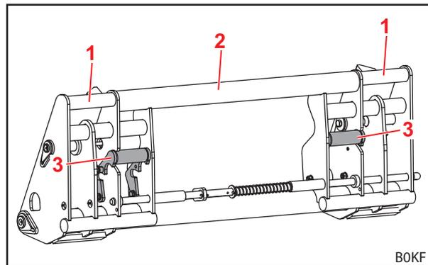
Fig. 18 Armação de troca combinada Euro-SMS (preparada para ferramenta SMS)
