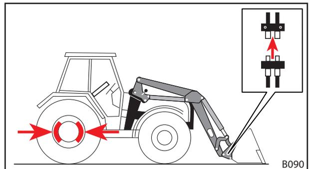
Fig. 106 Soltar os condutores hidráulicos
