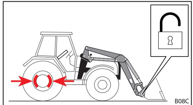
Fig. 105 Abrir o bloqueio da ferramenta
