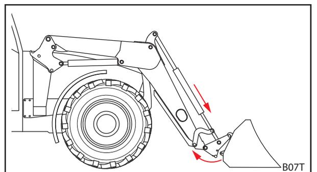
Fig. 107 Desenganchar a armação de troca
