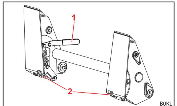
Fig. 16 Armação de troca Skid-Steer
