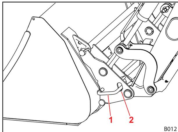
Fig. 82 Bloqueio mecânico da ferramenta
