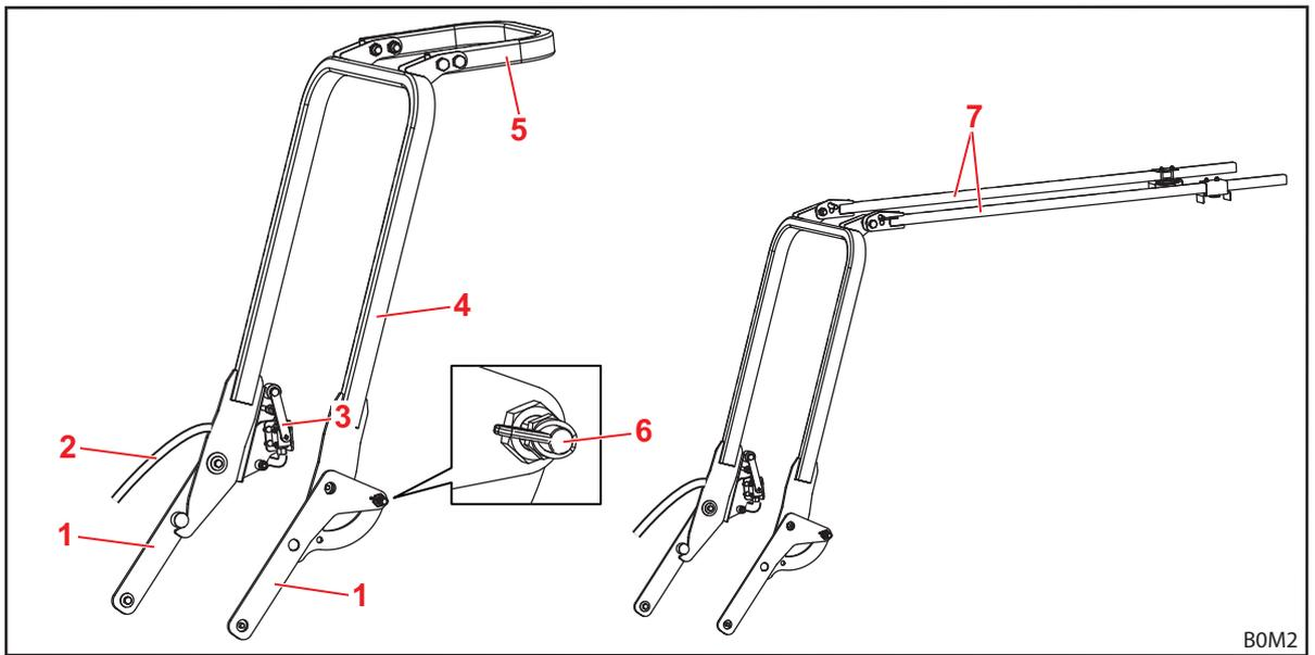
Fig. 12 O Operator Protective Guard, OPG, para tratores com dispositivo de proteção contra o capotamento de 2 postes montado na retaguarda (ilustração exemplar)
