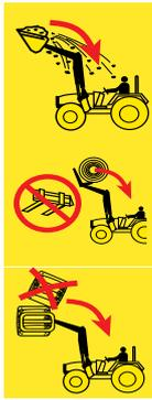
Existe perigo de morte devido a cargas levantadas que podem resvalar e cair no banco do condutor. Um risco elevado é ao levantar paletes ou fardos acima da cabina do condutor e ao trabalhar em inclinações. Também os sistemas de segurança habituais (dispositivo de proteção contra capotamento ROPS, estrutura de proteção contra queda de objetos FOPS) não oferecem uma proteção a 100%.
