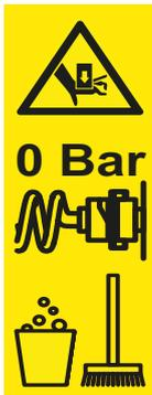
Existe perigo de esmagamento se as peças da máquina se movimentam de forma não controlada devido à inclusão de ar no sistema hidráulico.
