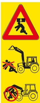
Existe perigo de esmagamento e de ferimento fatal devido aos movimentos imprevistos do trator, do carregador frontal e das ferramentas.
