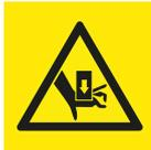
Existe perigo de esmagamento dos membros ao utilizar os apoios de descanso para estacionar o carregador frontal, principalmente e caso de solo irregular.
