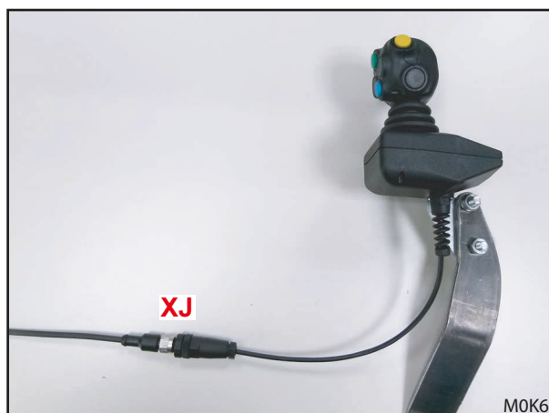
Rys. 35 Kabel przy manipulatorze
