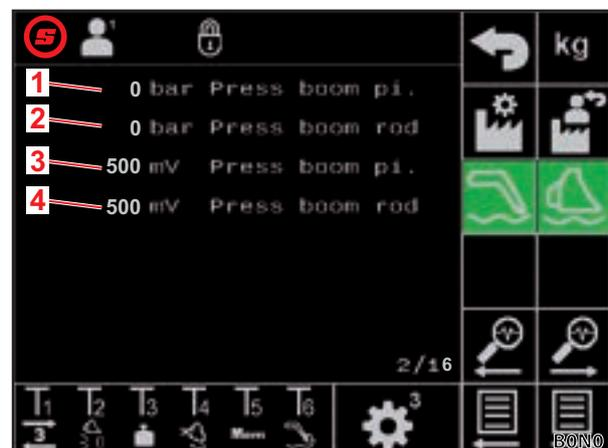
Sl. 38 Tlačni senzori oscilirajuće ruke
