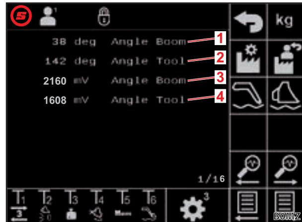
Sl. 37 Kutni senzori oscilirajuće ruke i opreme
