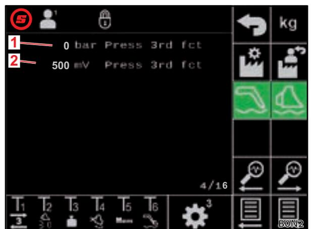
Sl. 40 Tlačni senzor u 3. upravljačkom krugu
