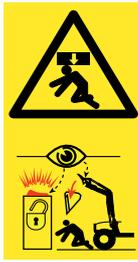
Sussiste il pericolo di lesioni gravi e di morte dovuto alla caduta di attrezzi oppure a causa di un abbassamento incontrollato del caricatore frontale, se vengono utilizzati attrezzi non adatti oppure gli attrezzi utilizzati sono sovraccaricati.
