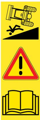
Sussiste pericolo di lesioni se il caricatore frontale ribalta durante il montaggio o lo smontaggio oppure il caricatore frontale deposto si ribalta per mancata stabilità.
