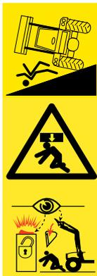
Sussiste il pericolo di gravi lesioni e di morte durante il caricamento e il trasporto del carico, se il caricatore frontale viene guidato unilateralmente, il carico viene sollevato troppo sopra il sedile del conducente oppure vengono utilizzati attrezzi non adatti.
