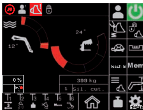
Mynd 36 Skjámynd fyrir veltivörn
