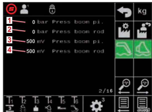
Σχ. 38 Αισθητήρες πίεσης του περιστροφικού βραχίονα
