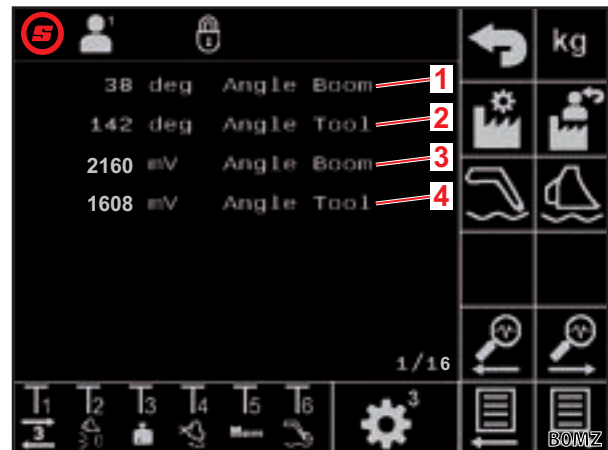
Σχ. 37 Αισθητήρες γωνίας περιστροφικού βραχίονα και εργαλείου
