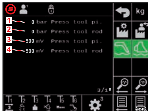
Σχ. 39 Αισθητήρες πίεσης του εργαλείου
