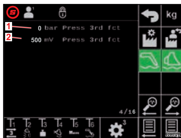
Σχ. 40 Αισθητήρας πίεσης στο 3ο κύκλωμα ελέγχου
