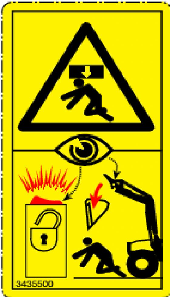
*Avant chaque utilisation du chargeur, vérifier visuellement la position des interrupteurs électriques et le verrouillage des outils sur le brancard;*
