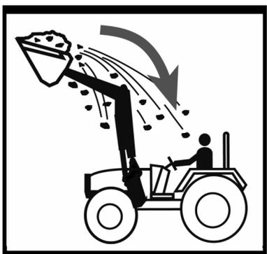
*L'outil d'un chargeur HD sans parallélogramme, ou HDP avec parallélogramme débrayable, modifie son inclinaison lors de la montée du bras. L'utilisateur doit modifier manuellement l'angle d'inclinaison de l'outil, de manière à éviter la chute de chargement et de ne blesser personne.*
