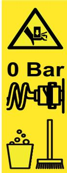
Il y a un risque d'écrasement si les composants de la machine exécutent des mouvements incontrôlés en raison de la présence de bulles d'air dans le système hydraulique.
