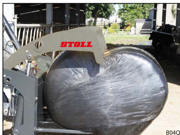
Fig. 37 Presser les balles rondes contre le cadre principal
