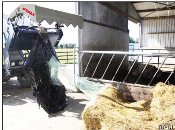
Fig. 41 Retirer l'enveloppe en plastique
