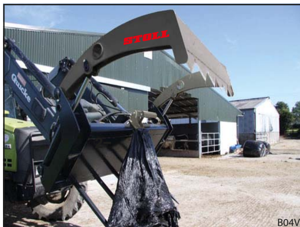
Fig. 42 Décharger l'enveloppe plastique
