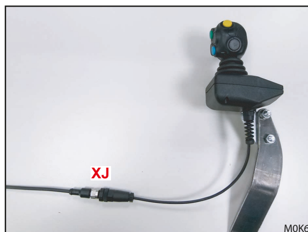
Fig. 35 Câble sur la manette
