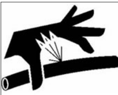
Illust. 4: Risque de blessure en raison d'une fuite d'huile hydraulique.
