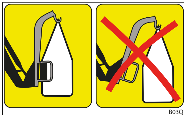
jn 79 Tööseadise nõuetekohane (vasakul) ja ebasobiv asend (paremal)
