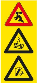
Es besteht Verletzungsgefahr durch Quetschen, Stoßen oder Einklemmen, wenn das Werkzeug umstürzt oder kippt bzw. vom Hebemittel abfällt.
