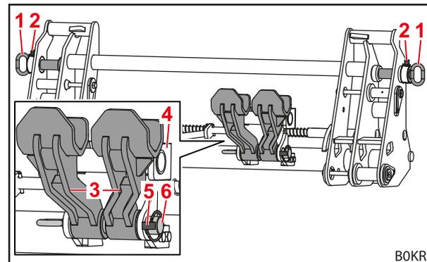
Abb. 77 Adapter in Parkposition (Wechselrahmen vorbereitet für Euro-Werkzeug)
