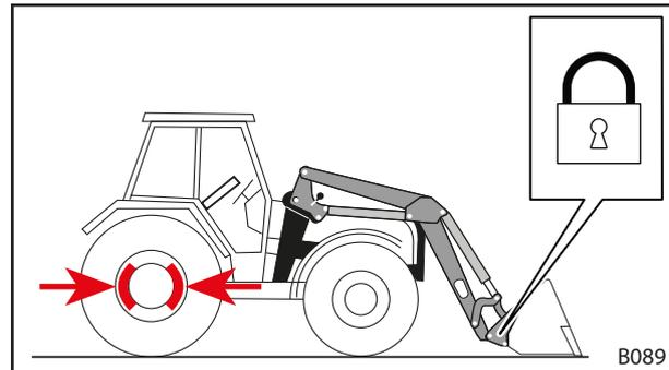
Abb. 88 Werkzeug-Verriegelung schließen
