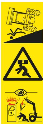
Es besteht schwere Verletzungs- sowie Lebensgefahr beim Laden und Transportieren von Last, wenn der Frontlader einseitig geführt wird, die Last zu weit über den Fahrersitz gehoben oder ungeeignete Werkzeuge verwendet werden.
