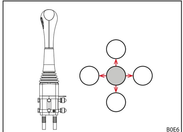
Abb. 53 Bedienhebel in alle Endlagen bewegen
