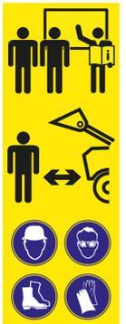
Es besteht Quetsch- und Stoßgefahr der oberen und unteren Gliedmaßen durch hervorstehende bzw. überstehende Rahmenteile und bewegliche Komponenten der Maschine.
