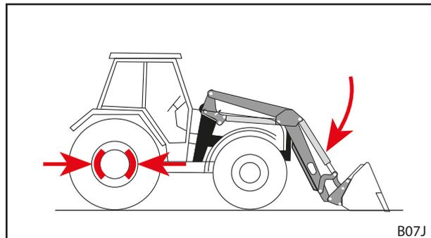
Abb. 105 Feststellbremse anziehen und Frontlader absenken
