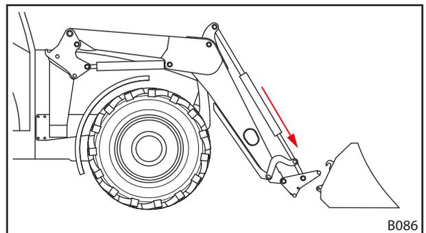
Abb. 80 Schwingen positionieren
