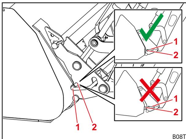
Abb. 69 Position der Verriegelungsbolzen prüfen
