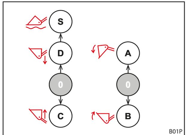
Abb. 49 Belegung bei zwei Bedienhebeln
