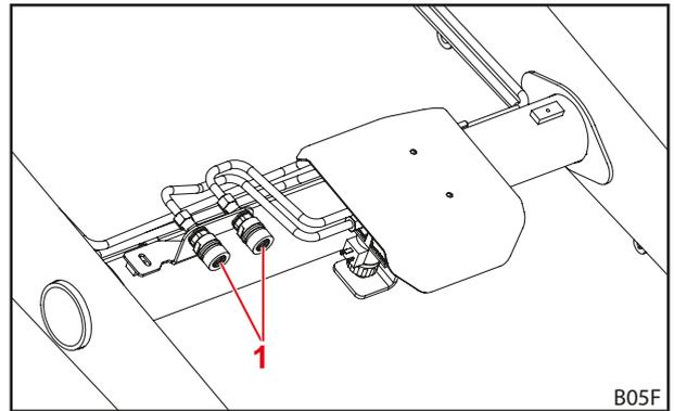
Abb. 30 Zusätzlicher 3. Steuerkreis
