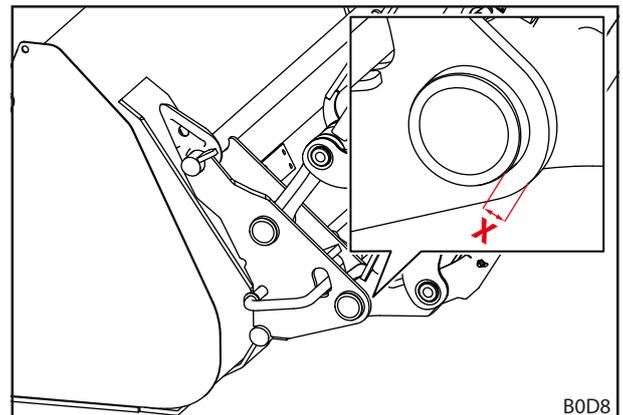
Abb. 104 Verschleißmaß des Wechselrahmens
