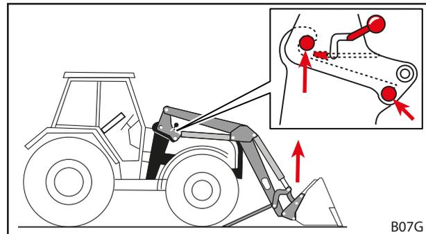
Abb. 41 Heben-Funktion verwenden, bis Frontlader-Bolzen in Fanghaken anliegen
