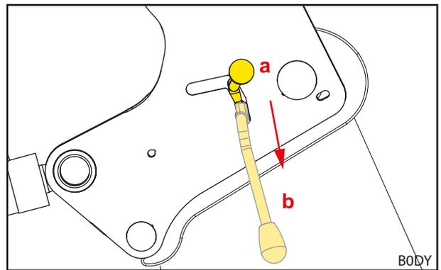
Abb. 46 Spannvorgang des Verriegelungshebels
