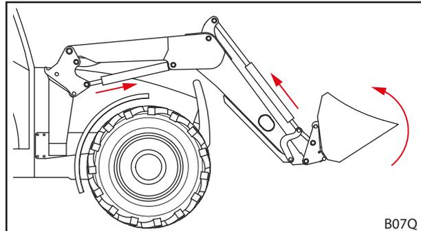
Abb. 83 Werkzeug-Verriegelung auslösen
