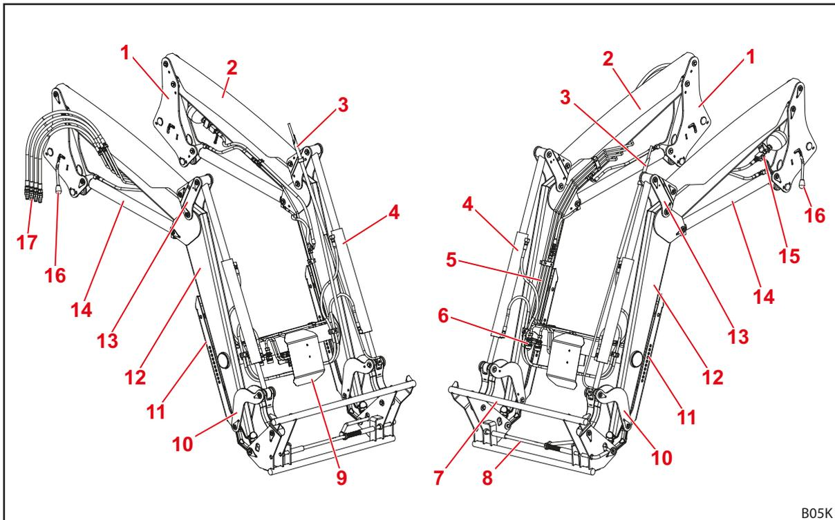
Abb. 8 Frontlader P (mit mechanischer Parallelführung)
