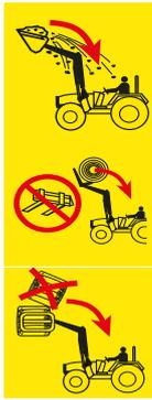
Es besteht Lebensgefahr durch angehobene Lasten, die auf den Fahrersitz stürzen können. Das Anheben von Paletten oder Ballen oberhalb der Fahrerkabine und das Arbeiten am Hang erhöhen das Risiko. Auch die gängigen Schutzsysteme (Umsturzschutzvorrichtung ROPS, Schutzaufbau gegen herabfallende Gegenstände FOPS) bieten keinen vollständig ausreichenden Schutz.
