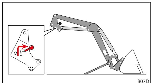
Abb. 38 Frontlader-Verriegelung öffnen
