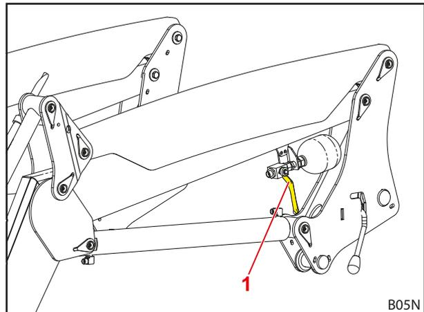
Abb. 32 Mechanisch betätigter Comfort-Drive
