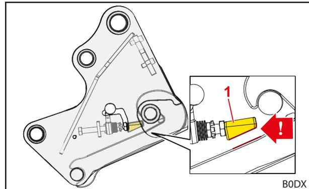
Abb. 43 Korrekte Einbauposition des Klemmkeils
