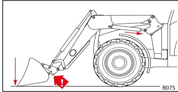
Abb. 70 Werkzeug auf den Boden drücken
