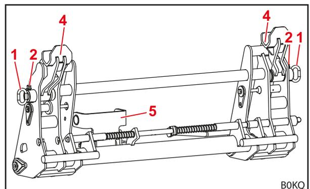
Abb. 16 Kombi-Wechselrahmen Euro-FR (vorbereitet für FR-Werkzeug)
