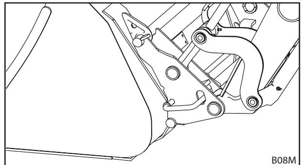
Abb. 79 Werkzeug-Verriegelung öffnen
