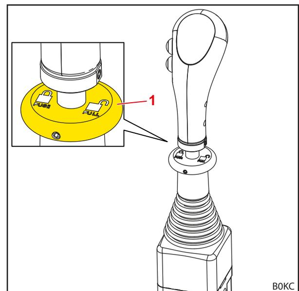
Abb. 52 Verriegelung des Bedienhebels (vertikale Verriegelung)
