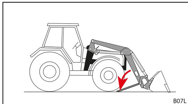
Abb. 107 Abstellstützen ausklappen
