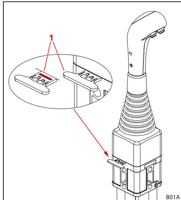
Abb. 51 Verriegelung des Bedienhebels (horizontale Verriegelung)
