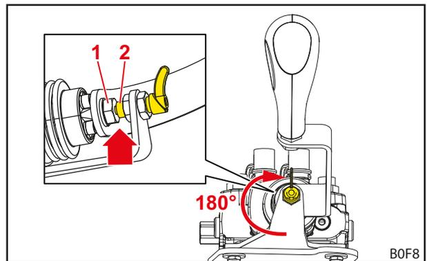
Abb. 55 Verriegelter Bedienhebel
