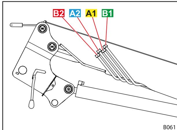
Abb. 17 Hydraulikleitungen
