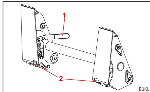
Abb. 11 Skid-Steer-Wechselrahmen
