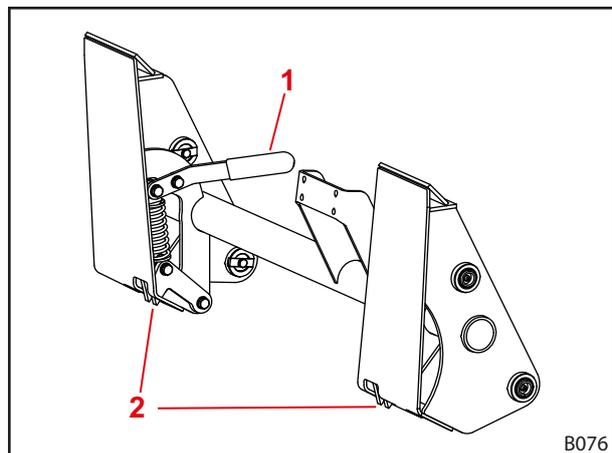
Abb. 71 Werkzeug-Verriegelung am Skid-Steer-Wechselrahmen
