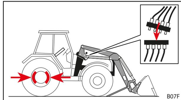
Abb. 40 Traktor abschalten und Hydraulikleitungen anschließen
