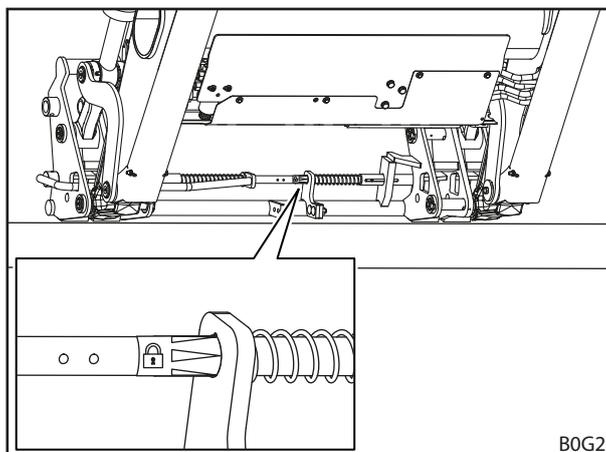
Abb. 68 Werkzeug-Verriegelung anhand des Aufklebers prüfen (Kombi-Wechselrahmen Euro-FR)
