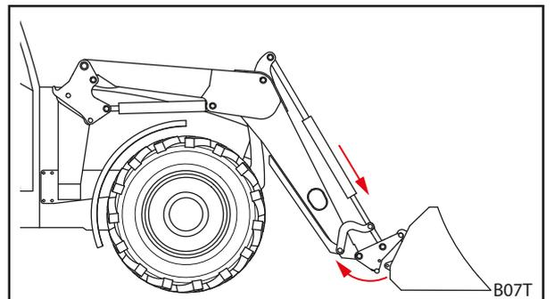
Abb. 91 Wechselrahmen aushaken
