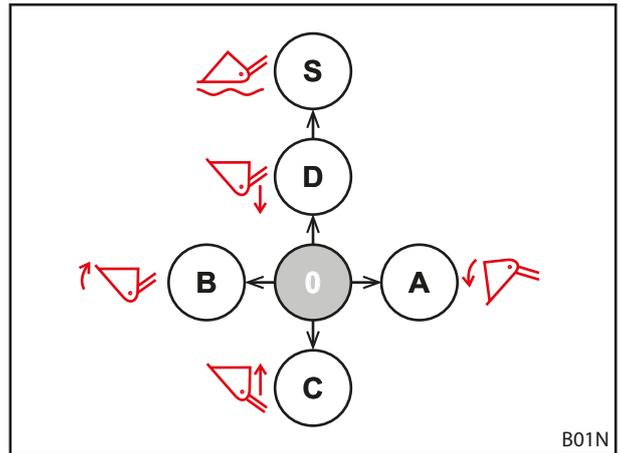
Abb. 48 Belegung bei einem Bedienhebel
