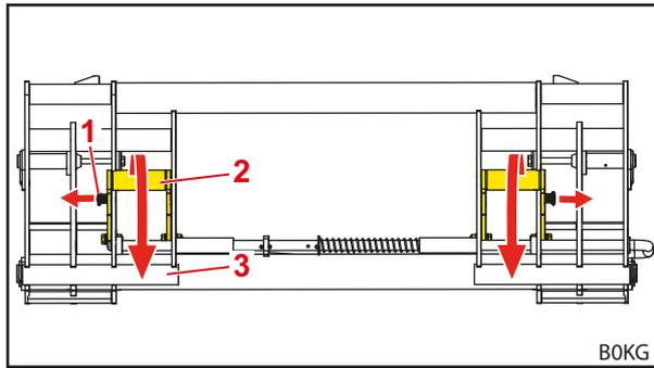
Abb. 73 Anlagen herunterschwenken
