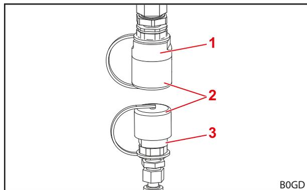
Abb. 64 Schraubkupplungen (beispielhafte Abbildung)
