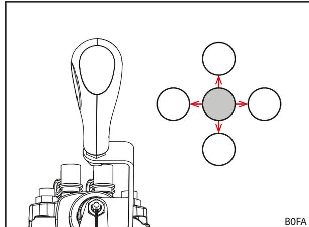
Abb. 57 Bedienhebel in alle Endlagen bewegen
