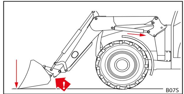
Abb. 72 Werkzeug auf den Boden drücken
