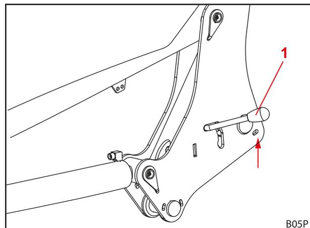
Abb. 44 Frontlader-Verriegelung öffnen
