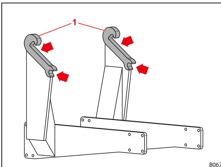
Abb. 99 Schmierstellen Frontlader-Aufnahmen
