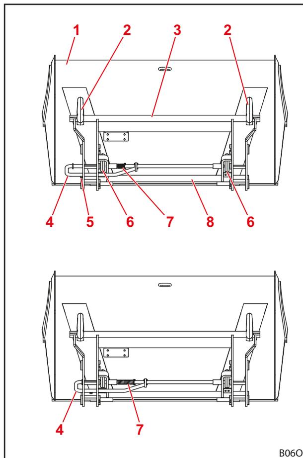
Abb. 21 Geöffnete (oben) und geschlossene (unten) Verriegelung
