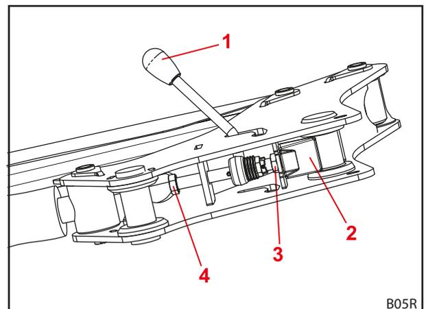
Abb. 47 Ansicht der Frontlader-Verriegelung von unten
