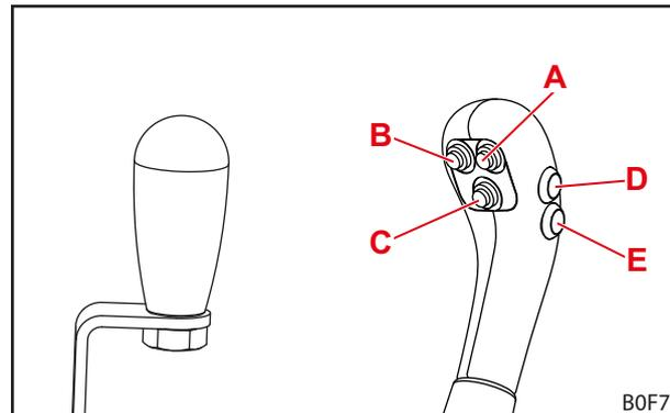
Abb. 54 Bedienhebel ohne Taster (links) und Bedienhebel mit 5 Tastern (rechts)
