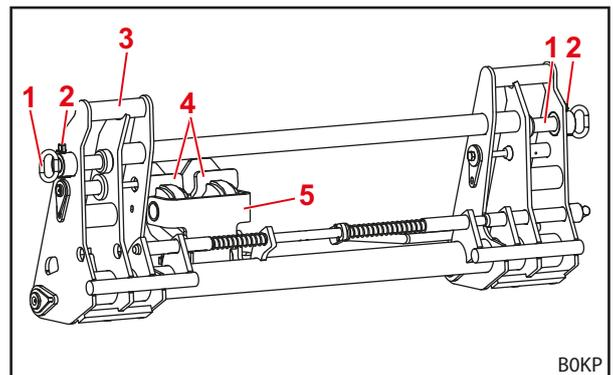
Abb. 15 Kombi-Wechselrahmen Euro-FR (vorbereitet für Euro-Werkzeug)
