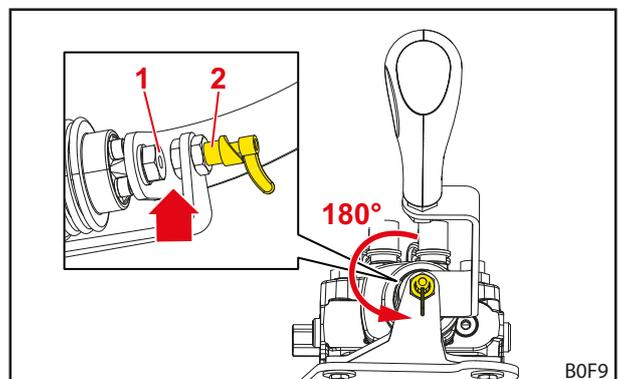
Abb. 56 Entriegelter Bedienhebel
