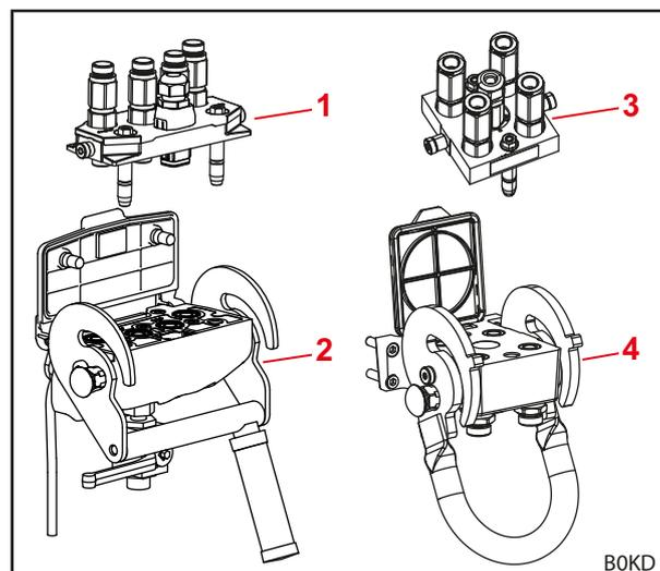
Abb. 20 Aufbau Hydro-Fix und Multikuppler
