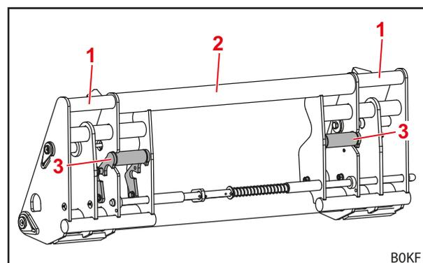
Abb. 13 Kombi-Wechselrahmen Euro-SMS (vorbereitet für SMS-Werkzeug)
