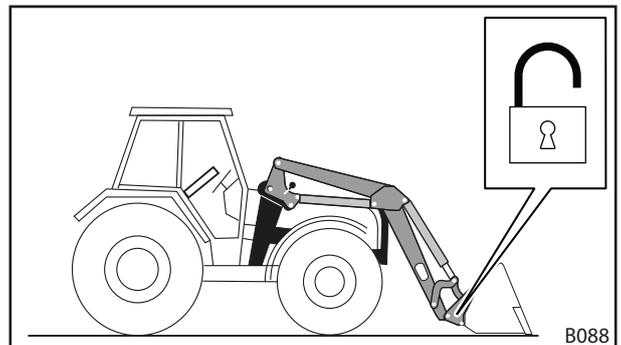
Abb. 85 Werkzeug-Verriegelung öffnen
