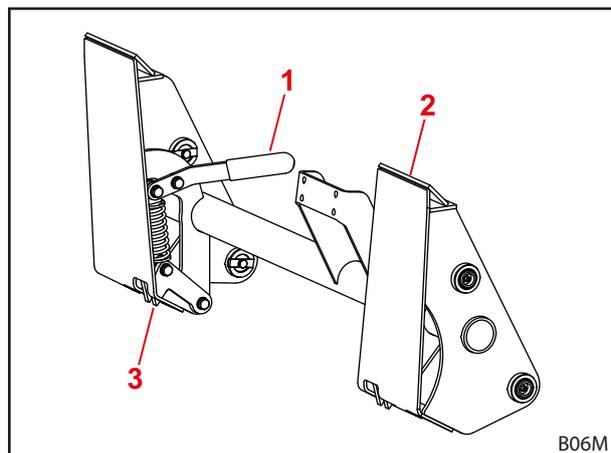
Abb. 22 Mechanische Werkzeug-Verriegelung an Skid-Steer-Wechselrahmen
