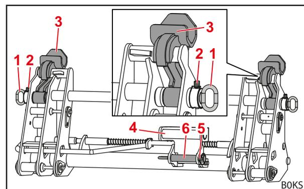
Abb. 78 Adapter in Arbeitsposition (Wechselrahmen vorbereitet für FR-Werkzeug)
