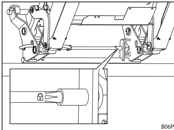
Abb. 67 Werkzeug-Verriegelung anhand des Aufklebers prüfen
