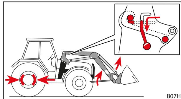
Abb. 42 Abstellstützen einklappen und Frontlader-Verriegelung schließen
