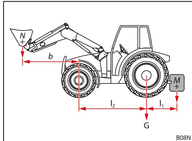
Abb. 37 Berechnung der statischen Standfestigkeit
