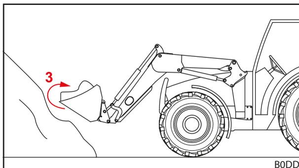
Abb. 96 Werkzeug nach hinten kippen und Ladegut aufnehmen
