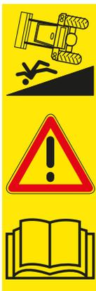
Es besteht Verletzungsgefahr, wenn der Frontlader beim An- oder Abbau umkippt oder der abgestellte Frontlader wegen mangelnder Standsicherheit umkippt.
