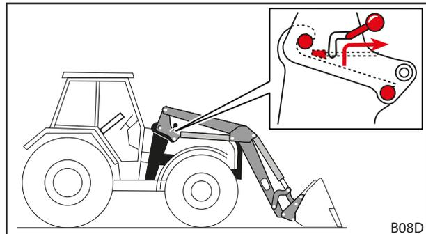
Abb. 106 Frontlader-Verriegelung lösen
