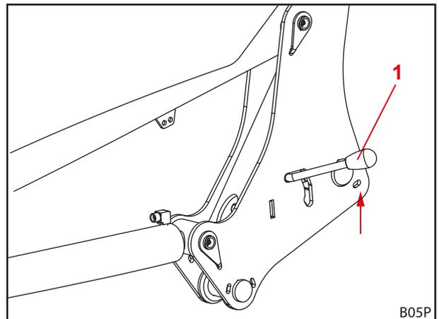
Abb. 103 Frontlader-Verriegelung prüfen
