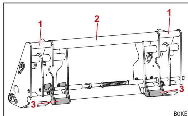
Abb. 12 Kombi-Wechselrahmen Euro-SMS (vorbereitet für Euro-Werkzeug)
