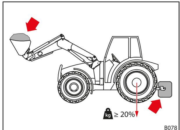
Abb. 35 Belastung bei Frontladerarbeiten
