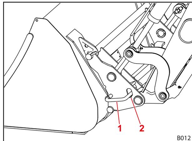
Abb. 66 Mechanische Werkzeug-Verriegelung
