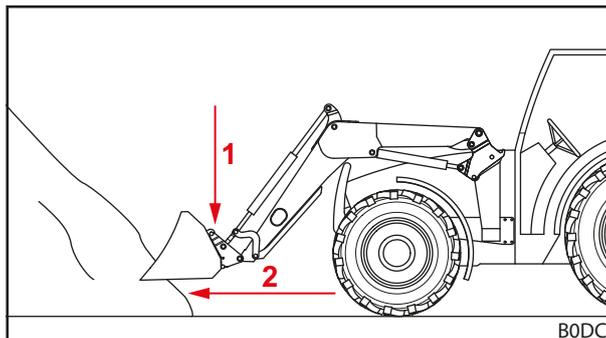
Abb. 95 Frontlader absenken und gerade in Ladegut einfahren
