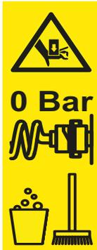
Es besteht Quetschgefahr, wenn sich Maschinenteile durch Lufteinschluss im Hydrauliksystem unkontrolliert bewegen.
