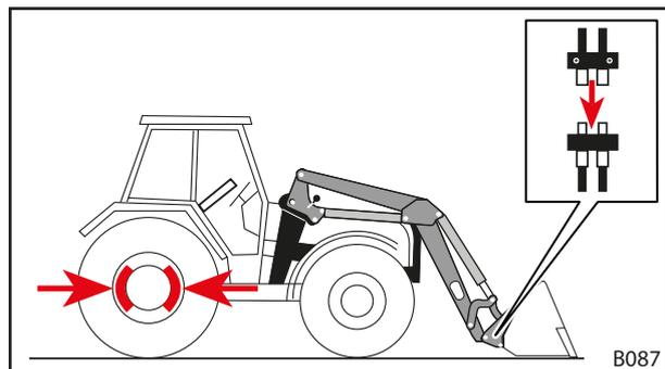
Abb. 84 Hydraulikleitungen des Werkzeuges mit Frontlader-Kupplungen verbinden
