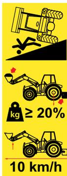
Es besteht schwere Verletzungs- bzw. Lebensgefahr durch Umkippen des Traktors bei Arbeiten am Hang, bei Kurvenfahrten, bei zu geringer Belastung der Hinterachse und bei schrägem Anfahren des Ladeguts.
