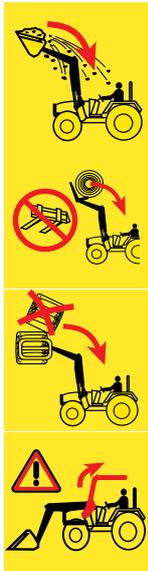
Es besteht Lebensgefahr durch angehobene Lasten, die auf den Fahrersitz stürzen können. Das Anheben von Gegenständen (z. B. Paletten oder Ballen) oberhalb der Fahrerkabine und das Arbeiten am Hang erhöhen das Risiko. Auch die gängigen Schutzsysteme (Umsturzschutzvorrichtung ROPS, Schutzaufbau gegen herabfallende Gegenstände FOPS) bieten keinen vollständig ausreichenden Schutz.
