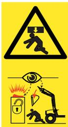
Es besteht schwere Verletzungs- und Lebensgefahr durch Absturz von Werkzeugen oder durch unkontrolliertes Absenken des Frontladers, wenn ungeeignete Werkzeuge verwendet oder die verwendeten Werkzeuge überlastet werden.
