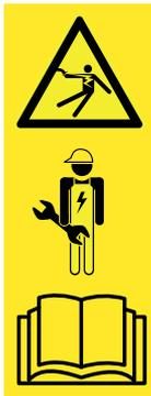
Es besteht Lebensgefahr durch Stromstoß beim Berühren unter Spannung stehender Maschinenteile, z. B. durch Kurzschluss im Bordnetz des Traktors.
