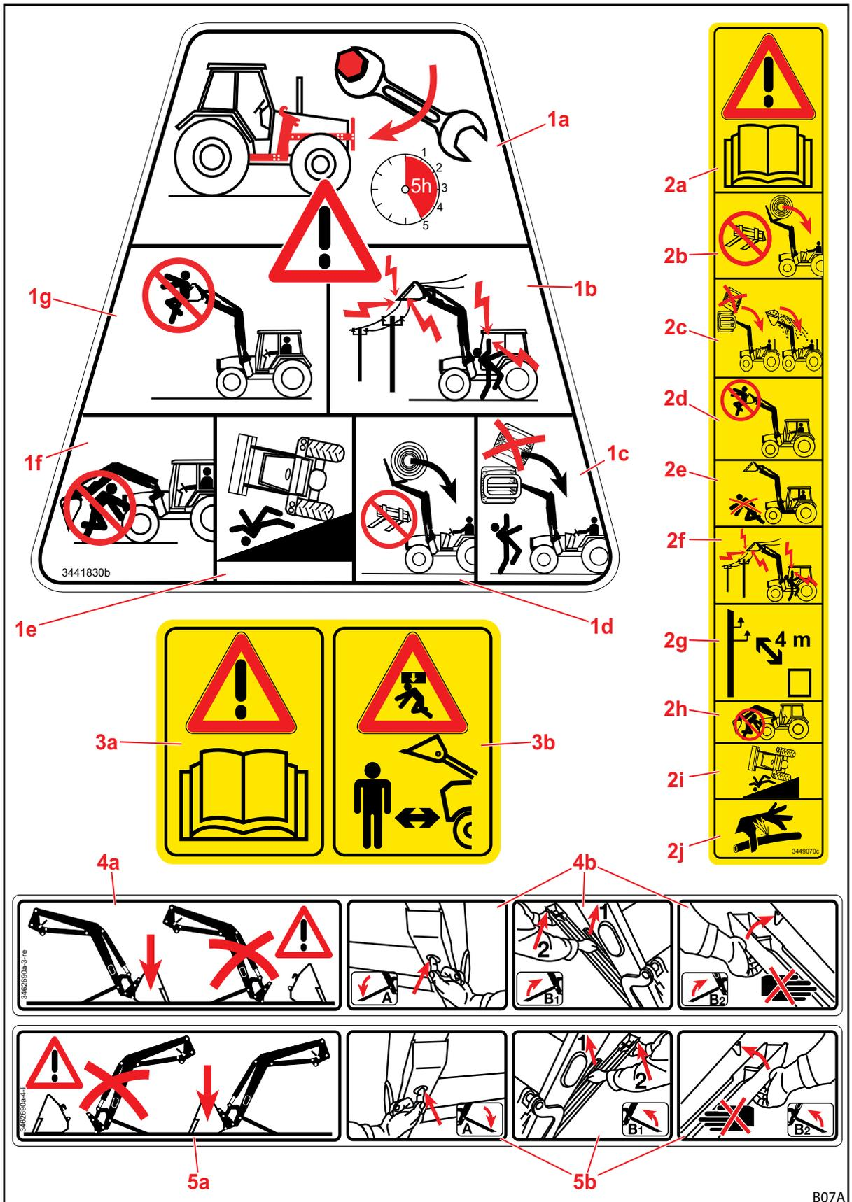
Abb. 5 Sicherheitsaufkleber Position 1-5
