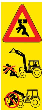
Es besteht Verletzungsgefahr durch Quetschen, Stoßen oder Einklemmen, wenn der Frontlader umstürzt oder kippt bzw. vom Hebemittel abfällt.
