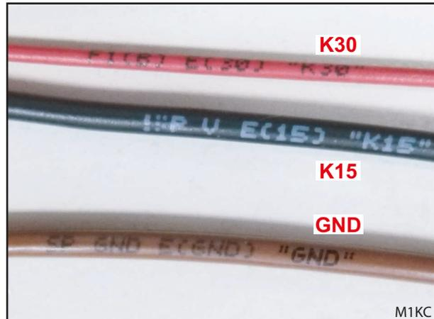
Abb. 40 Kennzeichnung der Kabel zur Spannungsversorgung
