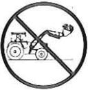
**Bei Straßenfahrten mit ausgehobenem Frontlader muß der Bedienungshebel gegen Senken verriegelt sein.**
