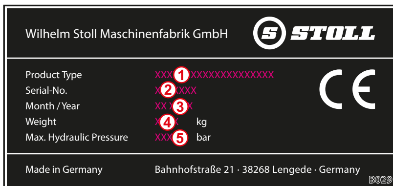
Фиг. 1 Фабрична табелка на предния товарач
