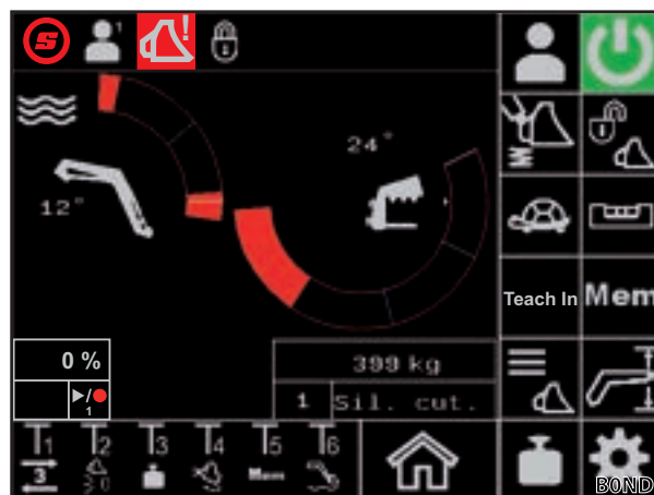
Фиг. 36 Индикация на защита от преобръщане
