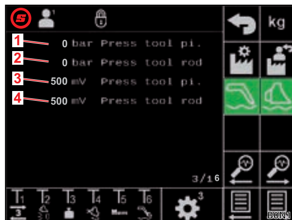
Фиг. 39 Сензори за налягане на инструмента
