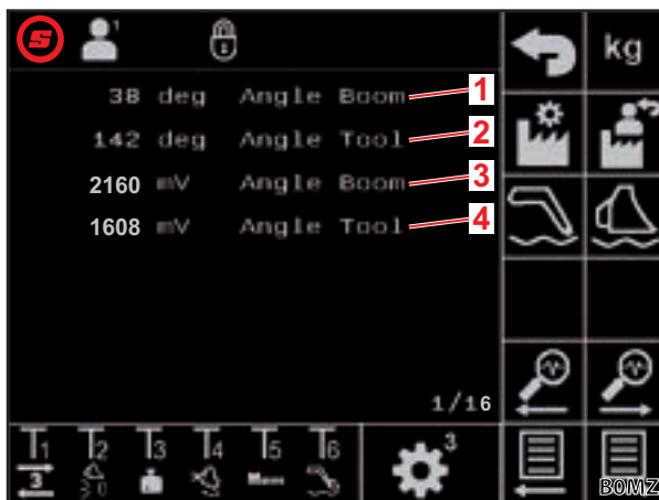
Фиг. 37 Сензори за ъгъла на стрелата и инструмента
