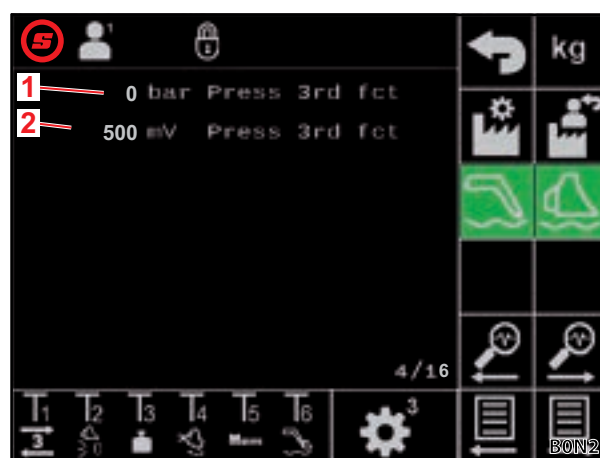
Фиг. 40 Сензор за налягане в 3-тата верига за управление
