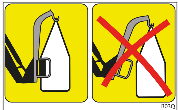
Фиг. 79 Правилно (вляво) и неподходящо положение (вдясно) на инструмента
